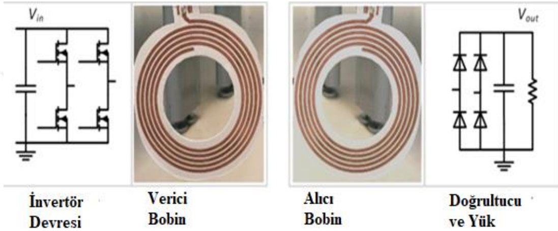
Şekil 3.25. Kablosuz güç transferini oluşturan temel güç elektroniği yapısı [82]
