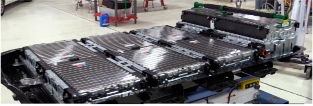
Şekil 3.8. EA için değişime hazır araç bataryaları görseli [48]
