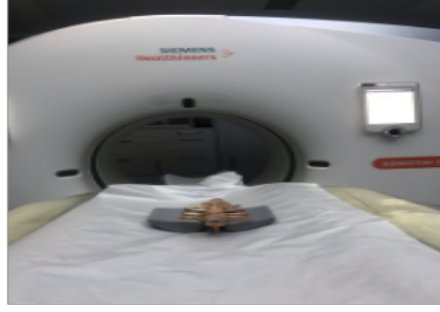
Şekil 26: SIEMENS HEALTHINEERS marka SOMATOM X.cite modeli 128 kesitli BT ile çekim yapılırken
