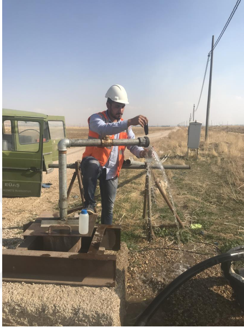
Şekil 3.3. A-68 no.lu kuyudan numune alımı.
