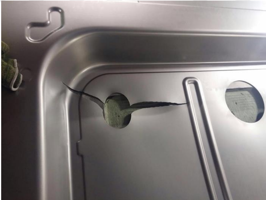
Şekil 5.1. Açınım boşaltmasında oluşan yırtık probleminin görseli
