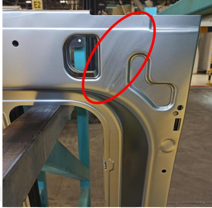
Şekil 3.10. Şekillendirilmiş bir parça üzerinde dalgalanma pot probleminin görünümü
