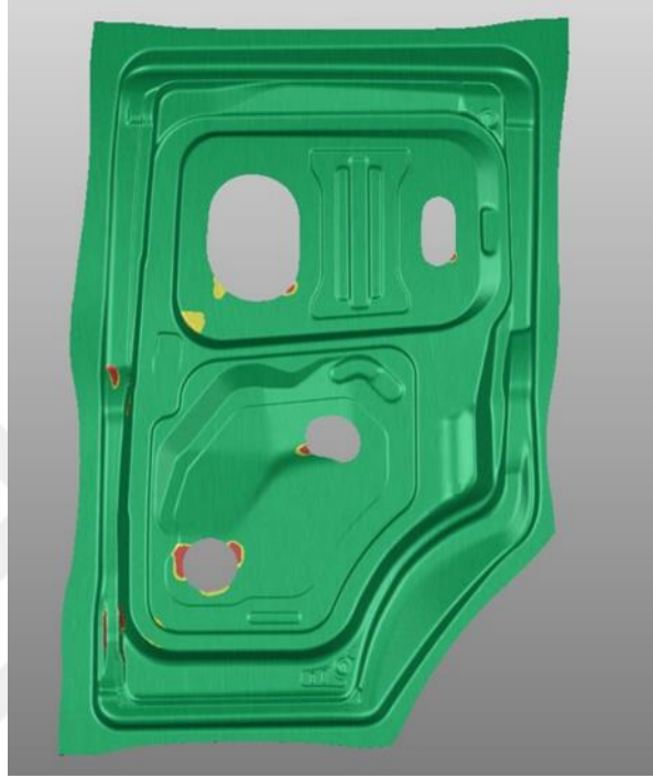
Şekil 3.2. Bir kayar kapı iç parçasının fizibilite aşamasından bir görünüm
