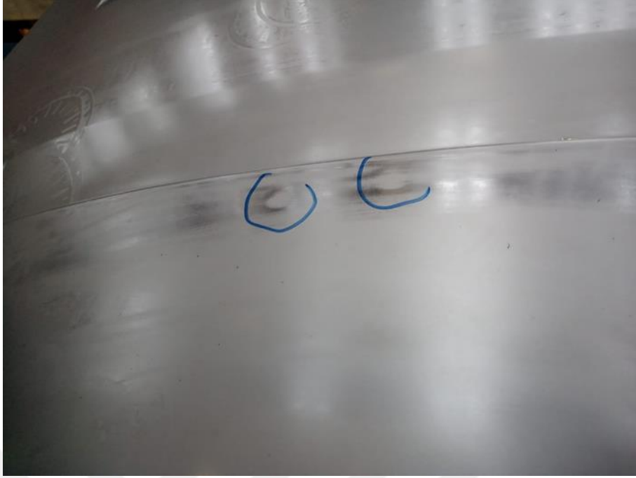
Şekil 3.11. Şekillendirilmiş bir parça üzerinde kalıp izi görünümü
