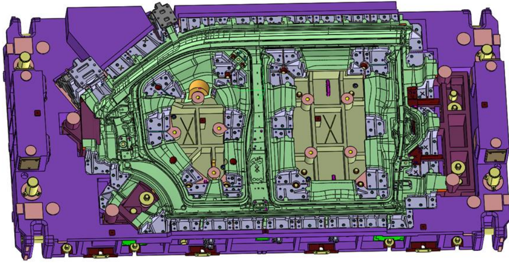
Şekil 2.9. Bir kesme üst kalıbının şematik gösterimi
