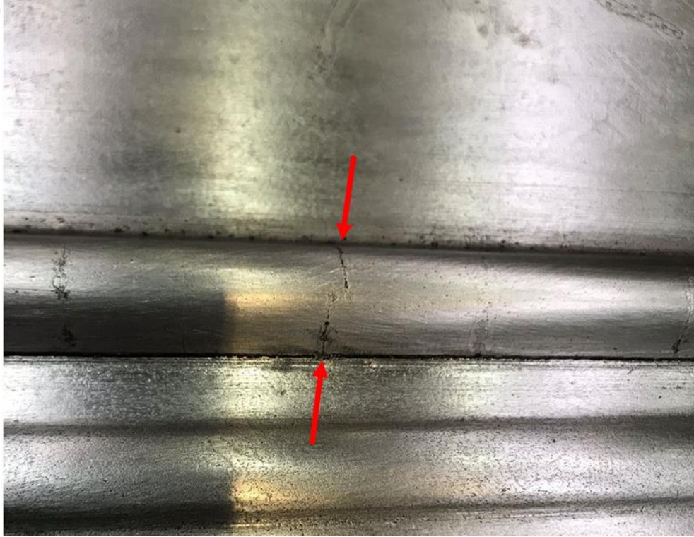
Şekil 3.6. Bir çekme kalıbı yüzeyinde oluşan çatlağın görünümü
