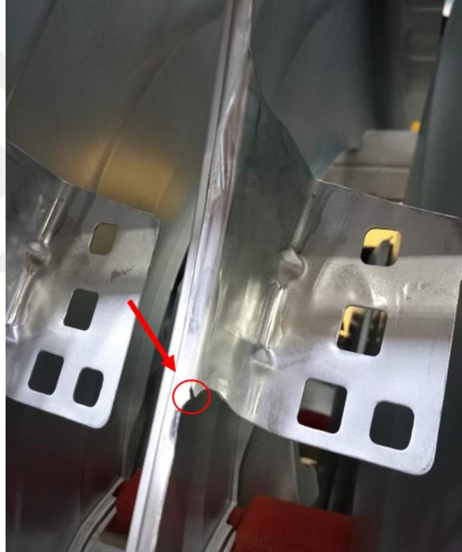
Şekil 3.9. Şekillendirilmiş bir parça üzerinde oluşmuş çatlak görünümü
