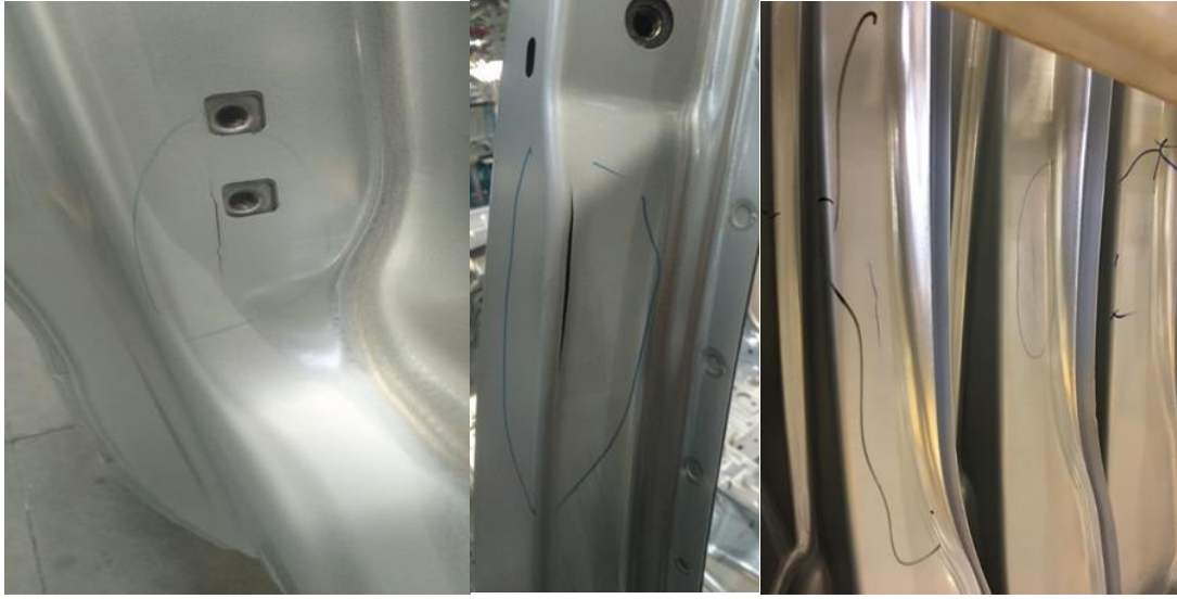
Şekil 3.1. Şekillendirilmiş sac üzerinde yırtık probleminin gösterimi
