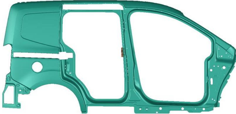
Şekil 2.7. Tüm operasyonları tamamlanmış, yarı mamul bir sac malzemenin şematik gösterimi.
