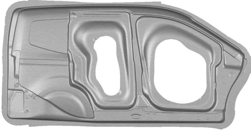
Şekil 2.6. Derin çekme operasyonundan elde edilmiş bir sac malzemenin şematik gösterimi
