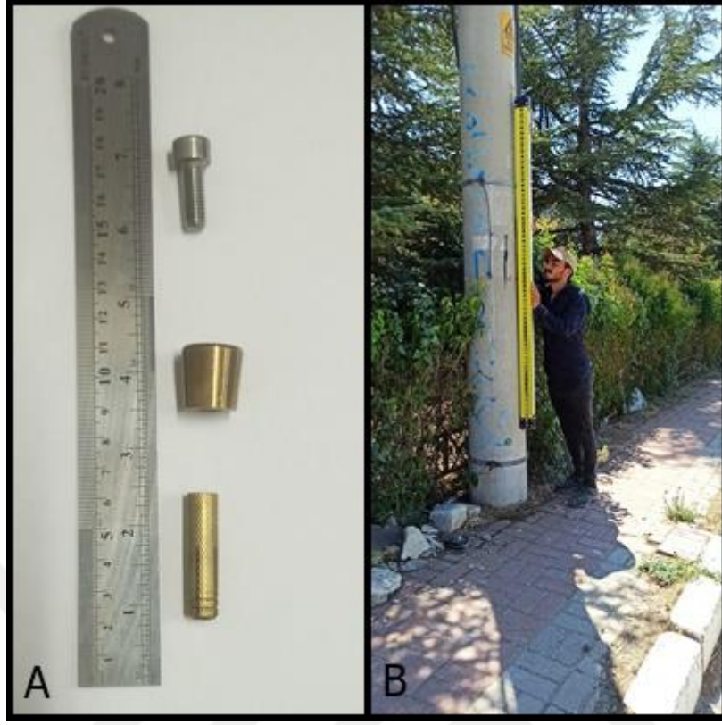
Şekil 4.3 A ile gösterilen fotoğraf tesis edilen RS aparatları, B ile gösterilen fotoğraf RS noktalarının tesis edildiği elektrik direklerini gösterilmektedir.
