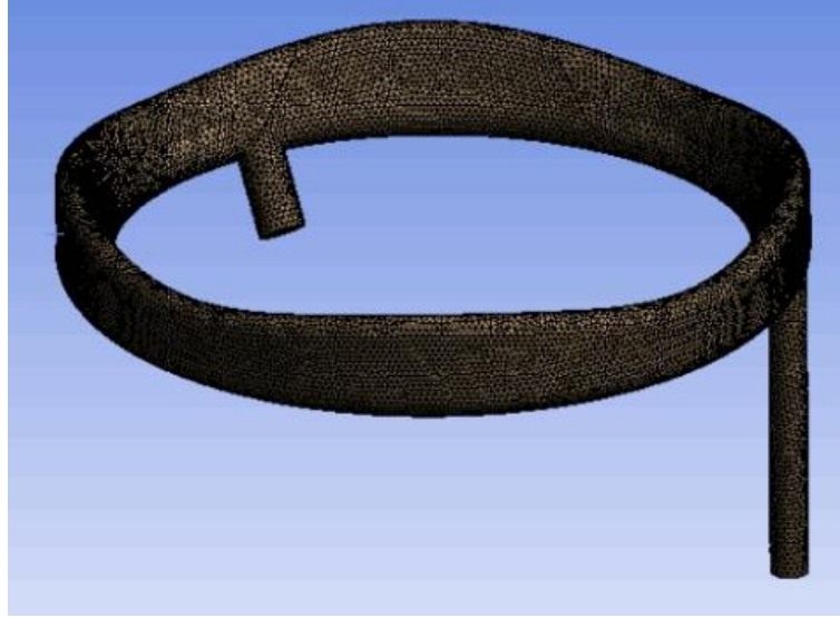
Şekil 3.17: Model-4 yağ galerisi ağ örgüsü görünümü
