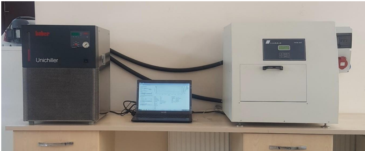
Resim 4.4. Linseis HFM 300/3 ölçüm düzeneği
