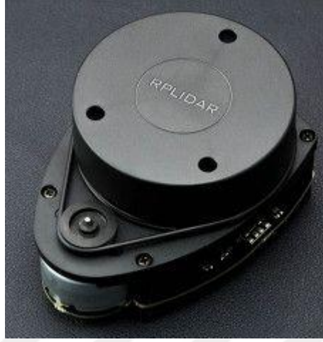
Şekil 18. RPLIDAR A1M8 LIDAR modülü
