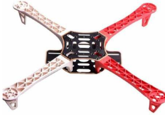
Şekil 3. İHA için kullanılan DJI F450 gövde ve PDB (Power Distributor Board)
