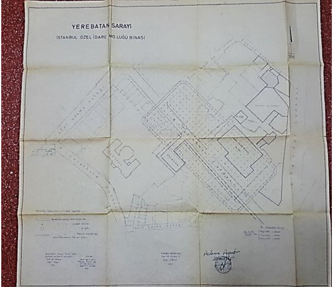
Şekil 4. 26. Yerebatan Sarnıcı sınırları üstünde inşaatına başlanılan İl Meclis Binası'nın projede Sarniç üstü oturumu
