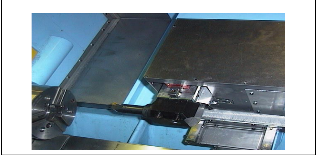
Şekil 2.13 Tornalama için hızlı doğrusal tahrikli eklentili uç tutucu
