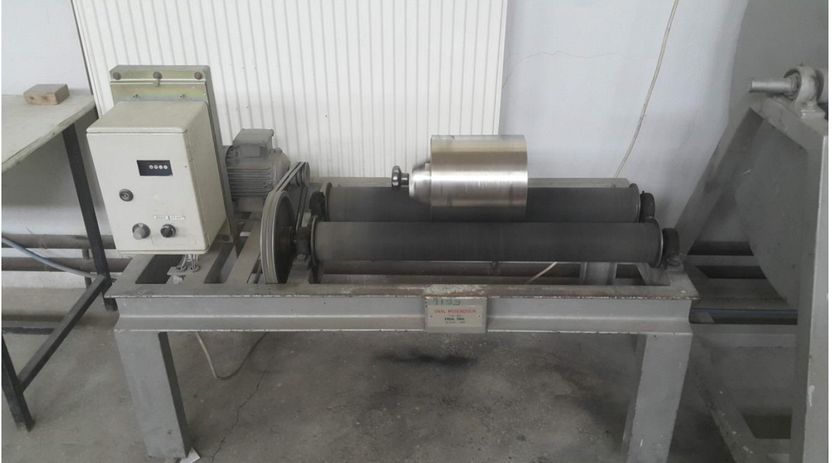
Őekil 3.3. Kavanoz tipi bilyalı deđirmende pirina klnn đtlmesi
