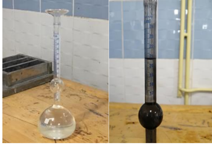
Şekil 3.5 Le chatelier balonu ile pirina külünün yoğunluğunun bulunması
