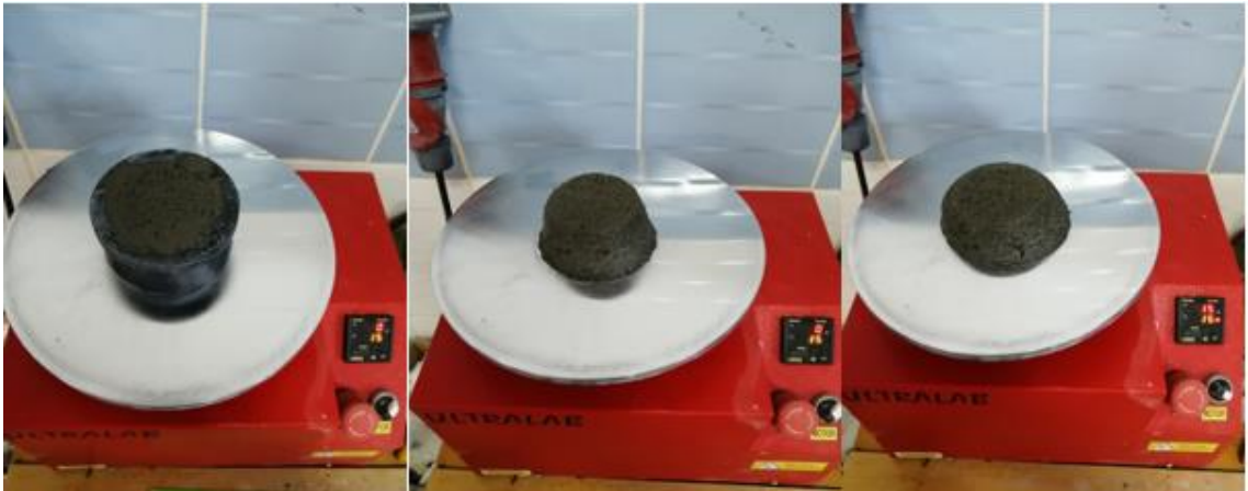
Şekil 3.9. Yayılma tablası deneyi
