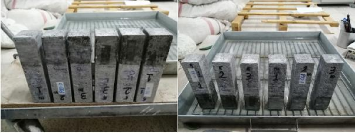
Şekil 3.11. Kılcal su emme deney numuneleri ve deney düzeneği
