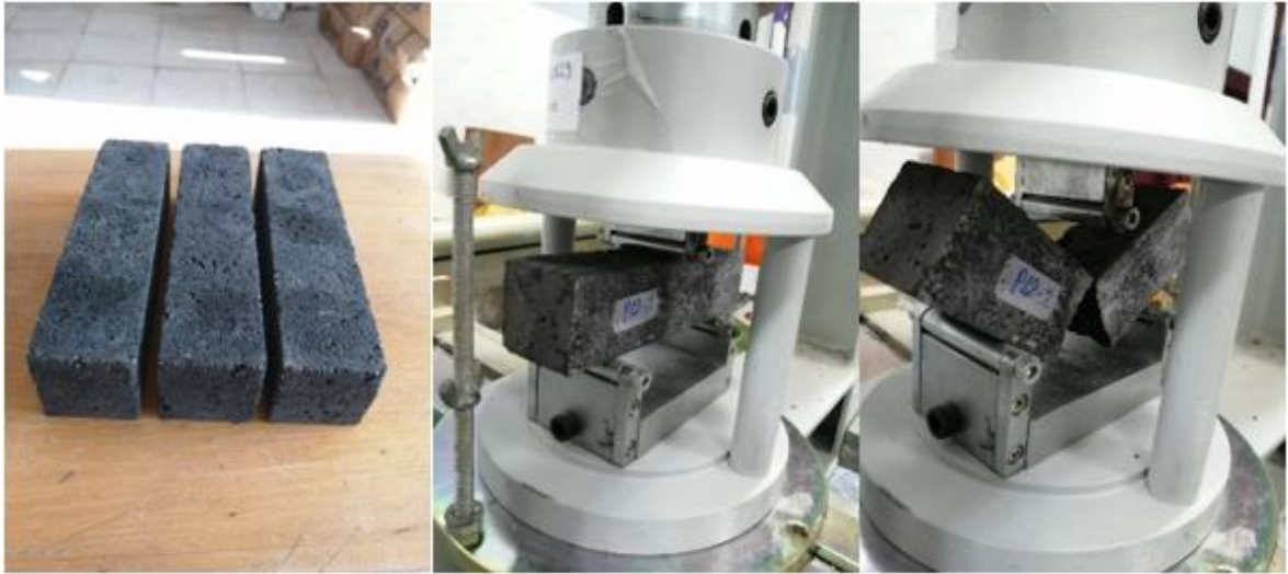
Şekil 3.13. Eğilme dayanımı deney numunesi ve düzeneği
