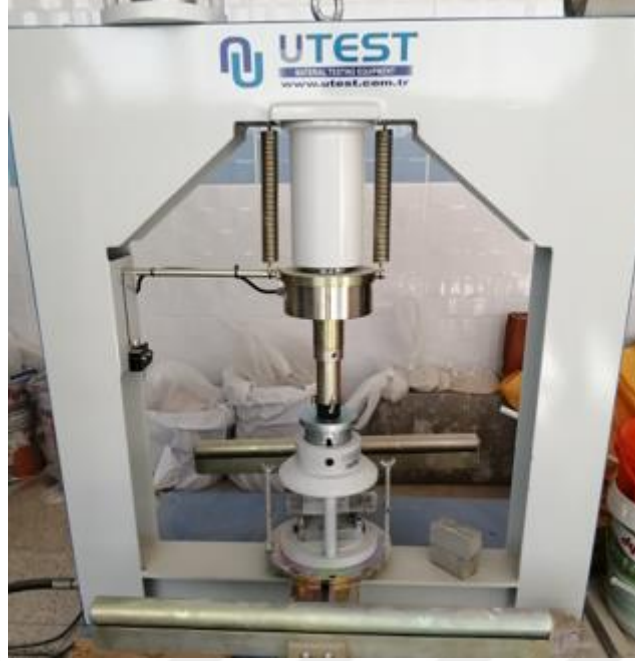
Şekil 3.12. Otomatik eğilme dayanımı deney presi
