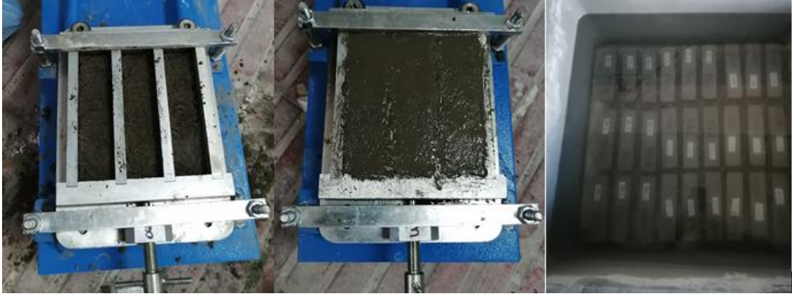
Şekil 3.7. Harç numunesinin kalıba yerleştirilmesi ve kür havuzunda bekletilmesi
