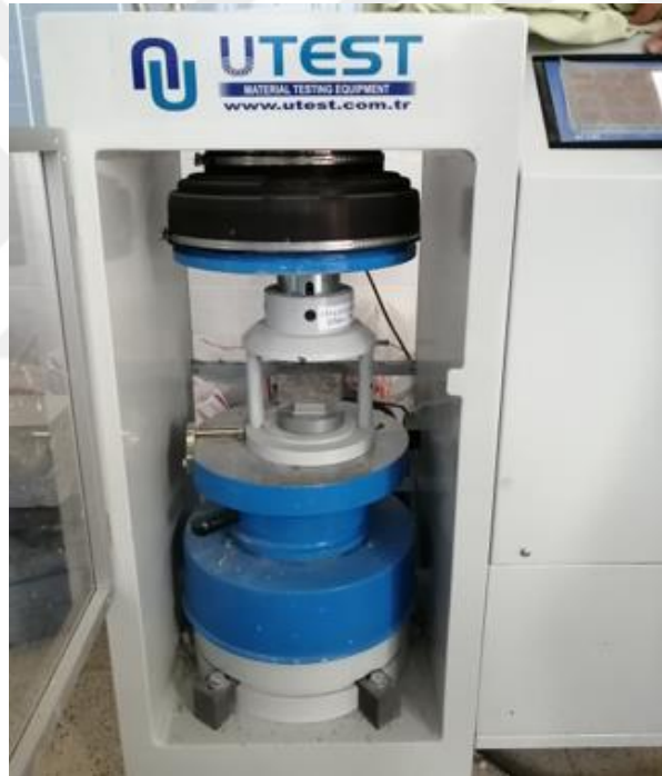
Şekil 3.14. Otomatik basınç dayanımı deney presi
