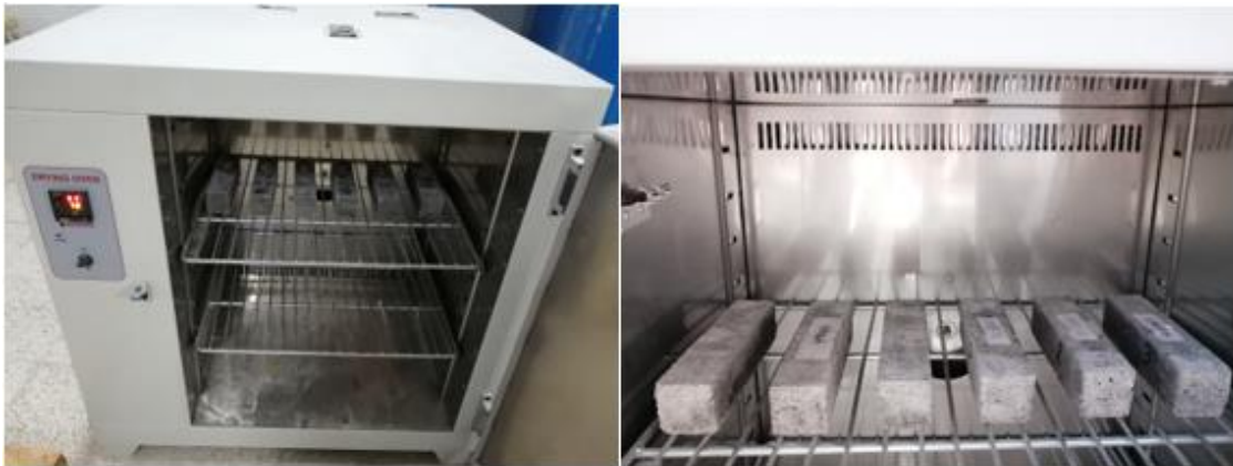
Şekil 3.10. Etüv ve etüvde kurutulan numuneler
