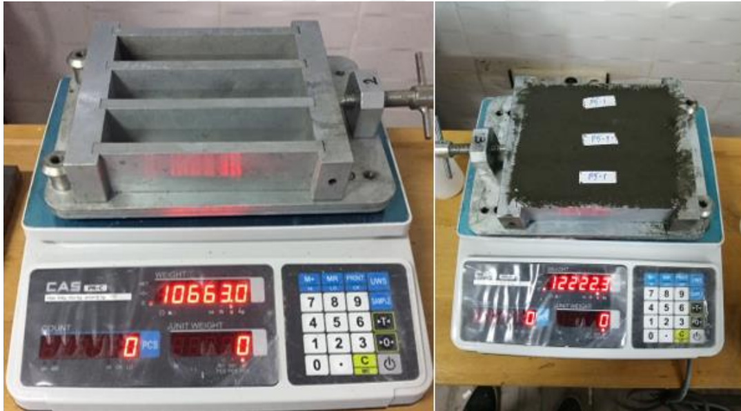
Şekil 3.8. Boş kalıp ve dolu kalıbın terazi yardımı ile ağırlığının bulunması
