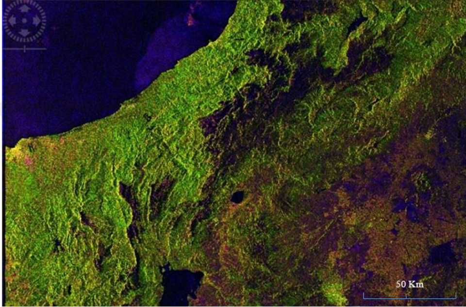
Şekil 4.2. Termal gürültüsü giderilmiş görüntü (R: Intensity_VV G: Intensity_VH B: Intensity_VV/Intensity_VH)
