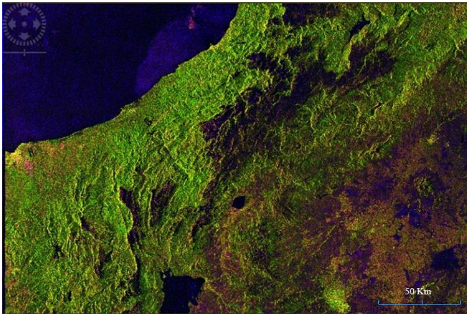
řekil 4.4. Çoklu bakıř uygulanmıř görüntü (R: Sigma0_VV, G: Sigma0_VH, B: Sigma0_VV/Sigma0_VH)
