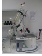
Şekil 3.6. Heidolph Laborota 4001 Efficient Rotary Evaporatör
