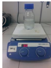
Şekil 3.25. Manyetik karıştırıcıda elektro lif çekim çözeltilerinin karıştırılması
