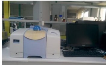
Şekil 3.18. Perkin Elmer Spectrum 100 FTIR Cihazı
