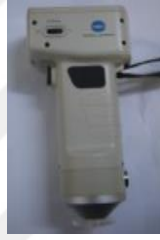
Şekil 3.20. Konica Minolta CR-400 Taşınabilir Reflektans Spektrofotometre
