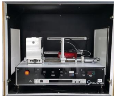
Şekil 3.16. Nanolifli yapıların üretim çalışmalarında kullanılan elektro lif çekim cihazı
