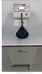
Şekil 3.22. SDL ATLAS M021A Hava Geçirgenliđi Test Cihazı
