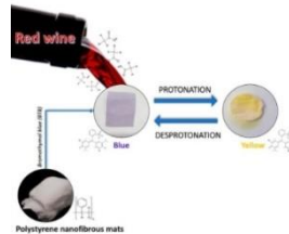
Şekil 2.16. Bromotimol mavisi içeren polistiren nanolifli (PSNF) yüzeyin şarap numunesinin pH değerine göre renk değişimi (Miranda ve ark. 2020)
