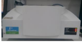
Şekil 3.19. Perkin Elmer STA6000 Termogravimetrik Analiz Cihazı
