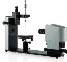
Şekil 3.11. Attension Theta Temas Açısı ve Yüzey Gerilimi Ölçüm Cihazı
