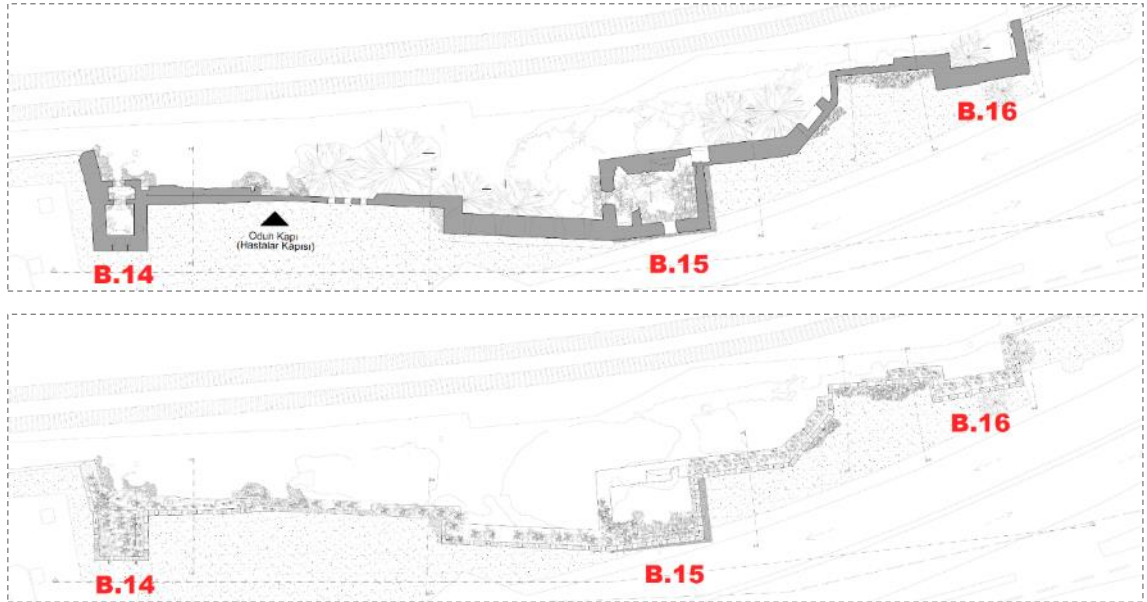
Şekil 3.315 B.16 burcu ile B.14 burcu arasındaki kısmın ara kesit (üstteki) ve üst kot (alttaki) rölöveleri (İRAM; Soyal) 192
