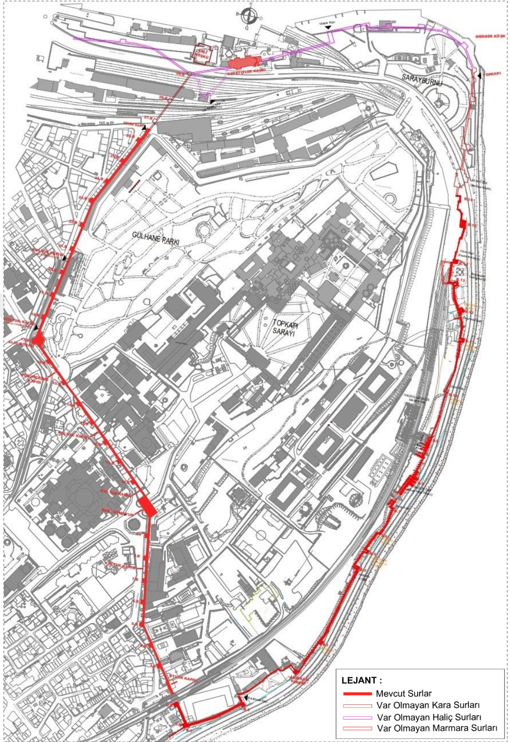
Şekil 3.6. Sur-i Sultani'nin günümüz halihazır durumuna ilişkin vaziyet planı rölövesi (İRAM; Soyal). 33
