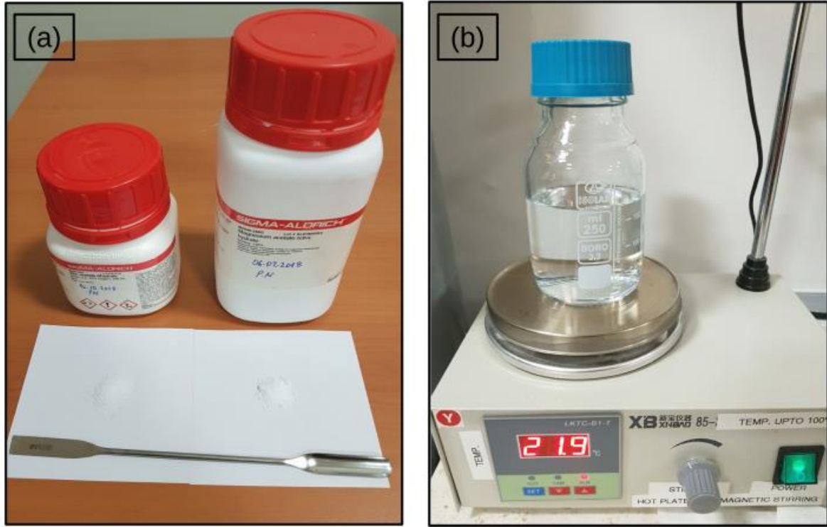
Resim 4.4. a) Çinko asetat dihidrat ve Magnezyum asetat tetrahidrat tuzları, b) Manyetik karıştırıcı yardımı ile çözeltinin hazırlanması
