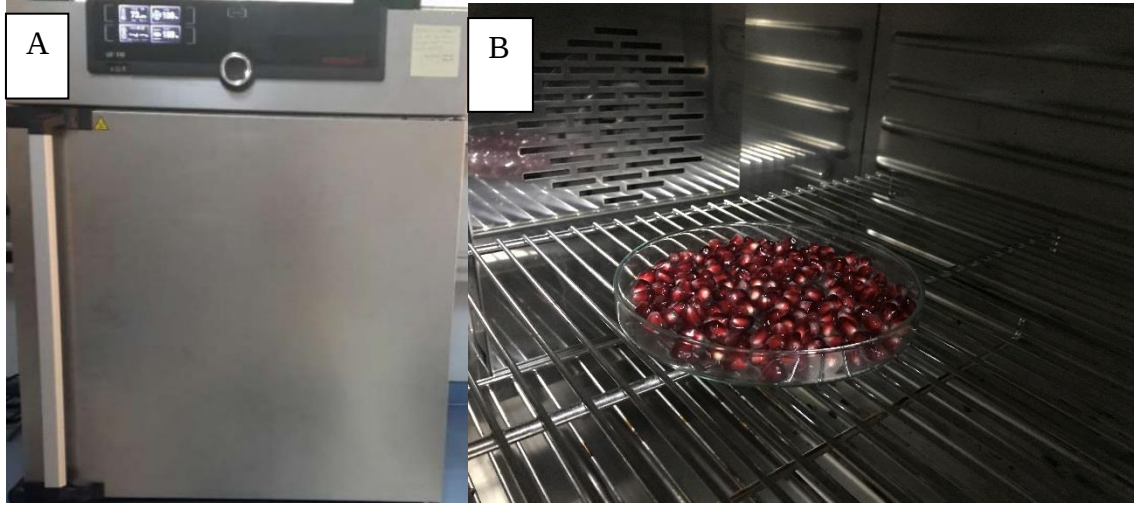
Şekil 3.2 (A) Kabin fırın; (B) Kabin fırında sıcak hava ile kurutulacak nar taneleri
