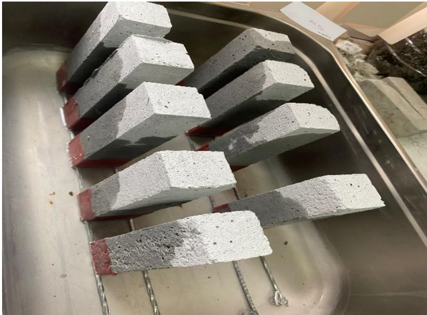
Şekil 3.8. Kılcal su emme tayini deneyi düzeneği
