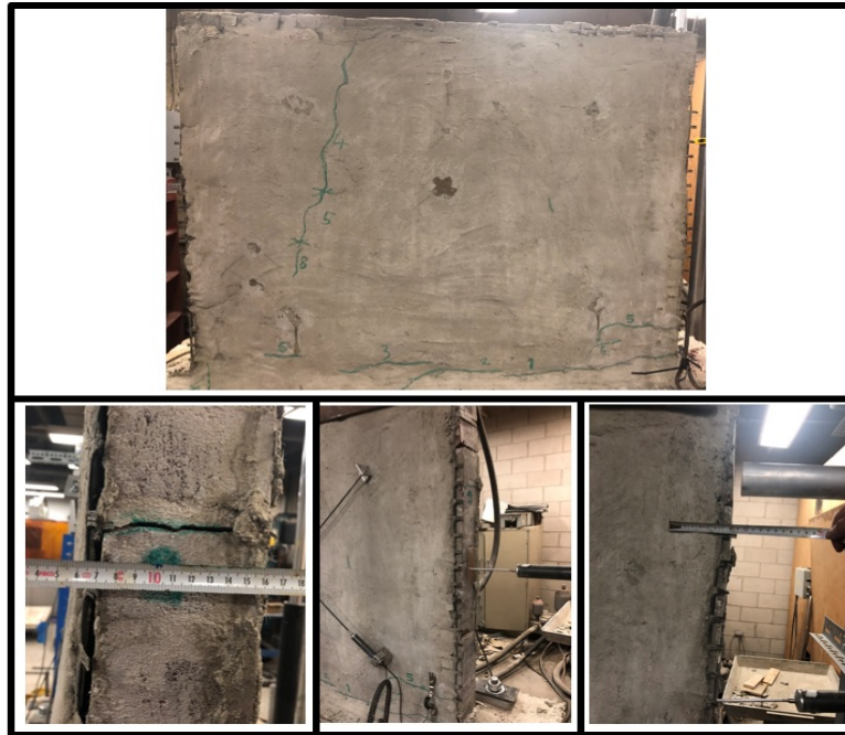
Şekil 3.65 : Duvar TD12YG'nin hasar tipi.
