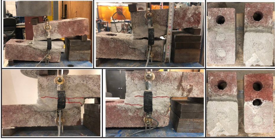
Şekil 3.11 : Z-şekilli numunelerde hasar tipleri.
