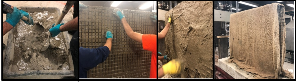
Şekil 3.49 : ECC2 harcın hazırlanması ve bazalt tekstil ile duvara uygulanma aşamaları.
