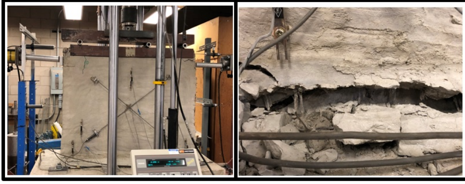
Şekil 3.56 : Duvar BD12YG'nin hasar tipi.
