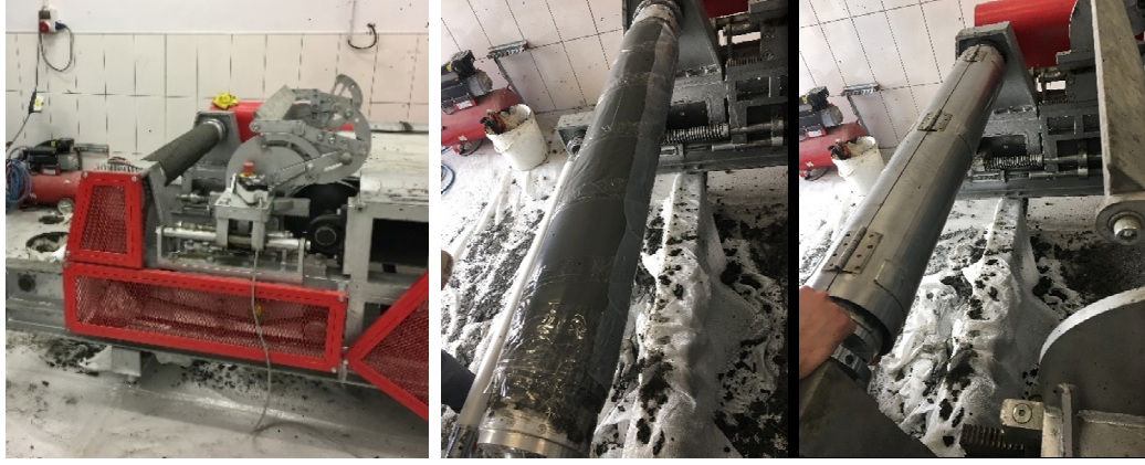
Şekil 5.3 : Üretilen silindir tüp TRCC'lerin kalıplanması.
