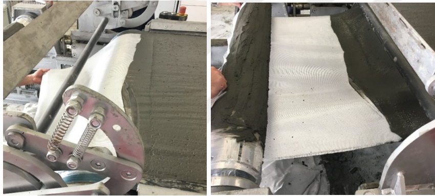
Şekil 5.2 : Silindir tüp form PVA TRCC üretim aşaması.
