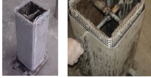
Kolon-tipi numune üretimi (Papanicolaou ve Papantoniou, 2010)
