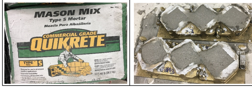
Şekil 3.3 : S-tip harç malzemesi ve kenar uzunluğu 5 cm olan küp harç numune kalıpları.
