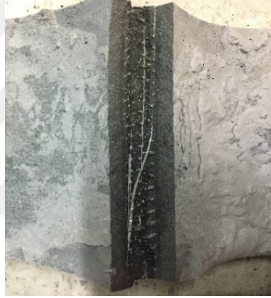
Şekil 5.14 : ARG6L numunelerde AR-glass tekstilin kopması.
