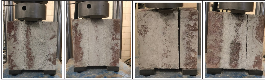
Şekil 3.14 : Üçlü kesme test sonuçlarından elde edilen numune hasar modları.
