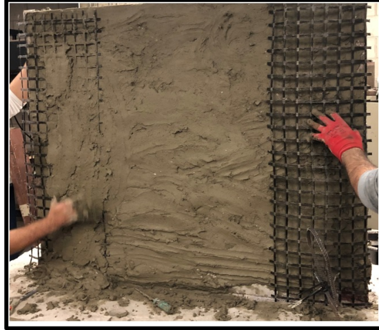
Şekil 3.60 : TD12 duvar numunesi yüzeyine uygulanan iyileştirme/güçlendirme.
