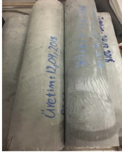
Şekil 5.4 : 100 cm uzunluğunda ARG4L, ARG6L ve PVA4L silindirik tüpler.
