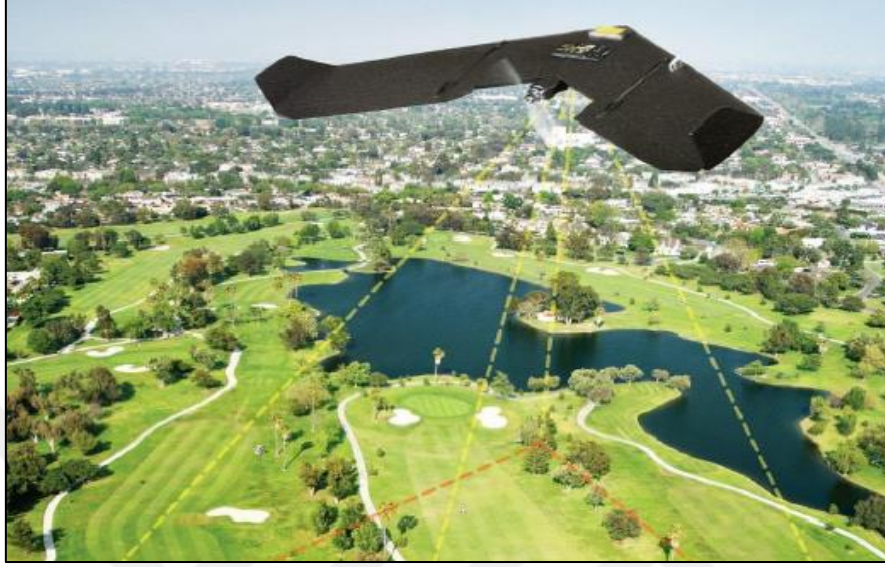
Şekil 2.4 İHA fotogrametri sistemi (URL 1).
