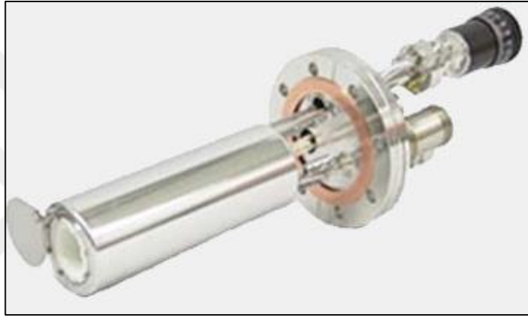
Şekil 4.16: Efüzyon hücresi mekanizması
