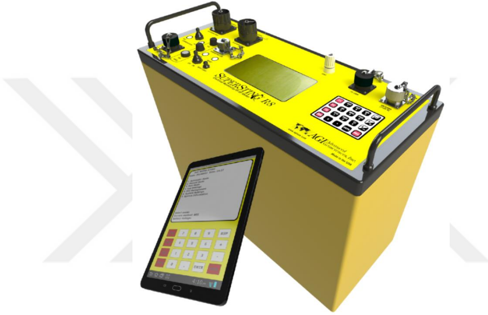
Şekil 4.12. Çalışmada kullanılan tam otomatik SuperSting özdirenç cihazı (AGI Advanced Geosciences, Inc.)
