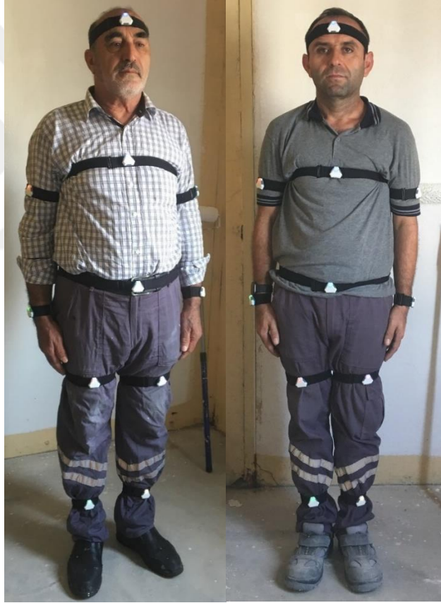
Şekil 3.6: Veri toplama öncesi sensör takılmış inşaat ustaları
