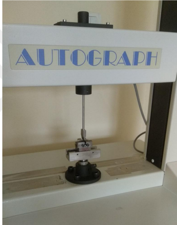
Resim 32: Universal test cihazında, geliştirilen düzener üzerinde deforme olmakta olan bir örnek
