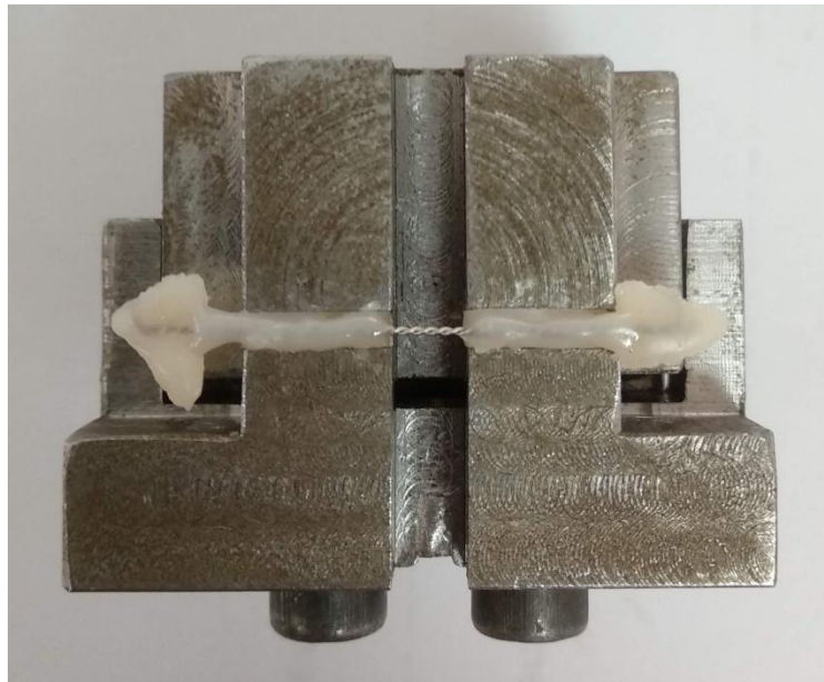
Resim 22: Örneğin bloklara pasif şekilde akışkan kompozit ile yapıştırılması
