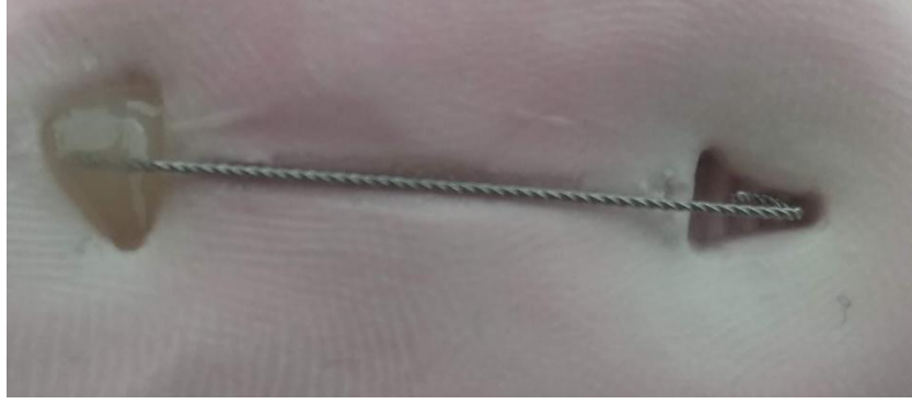
Resim 18: Retansiyon bükümleri yapılmış telin silikon kalıp içerisine yerleştirilip, kompozit örneklerin oluşturulması
