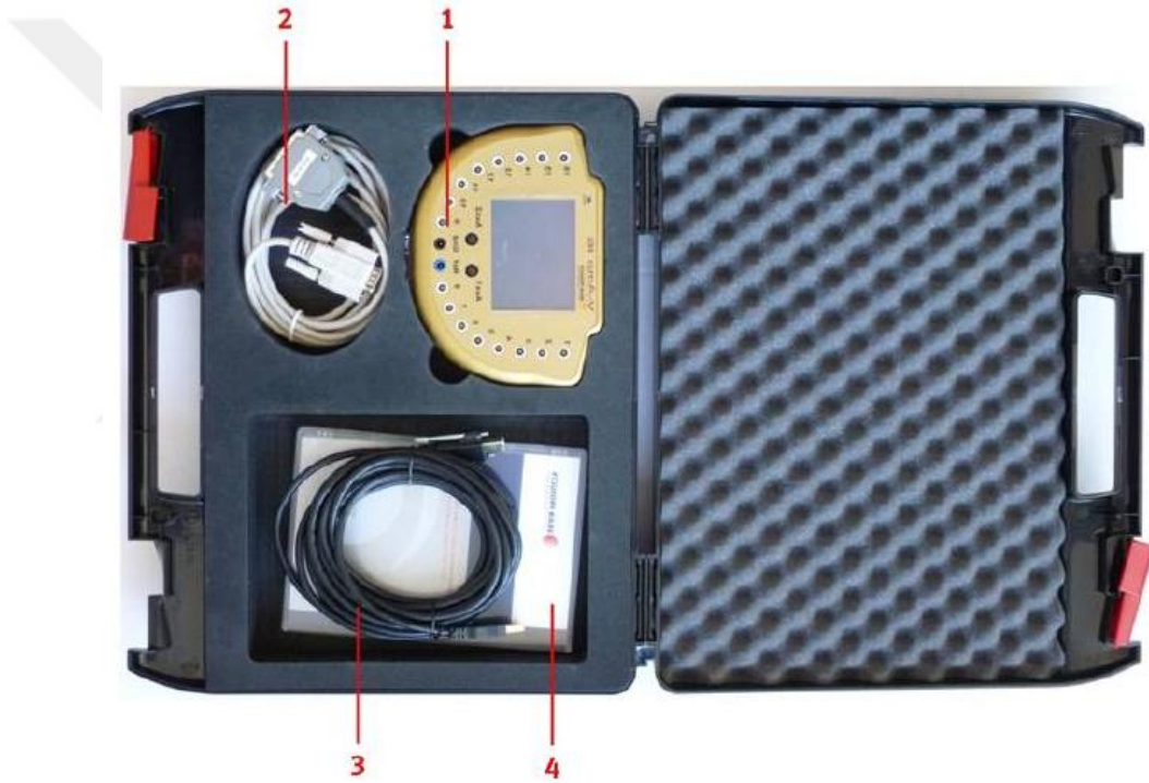
Şekil 2.4. Brain Products V-Amp 16 EEG kayıt aleti ve aksesuarları [18].
