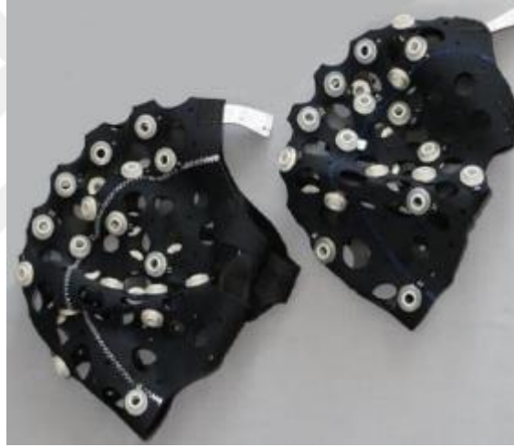
Şekil 2.8. Elektrotların uygun yerlere konumlanmasını sağlayan kep [19].
