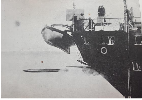
Fotoğraf 10- Whitehead Torpidonun Bir Fransız Kruvazörünün Kıçaltından Ateşlenmesi
