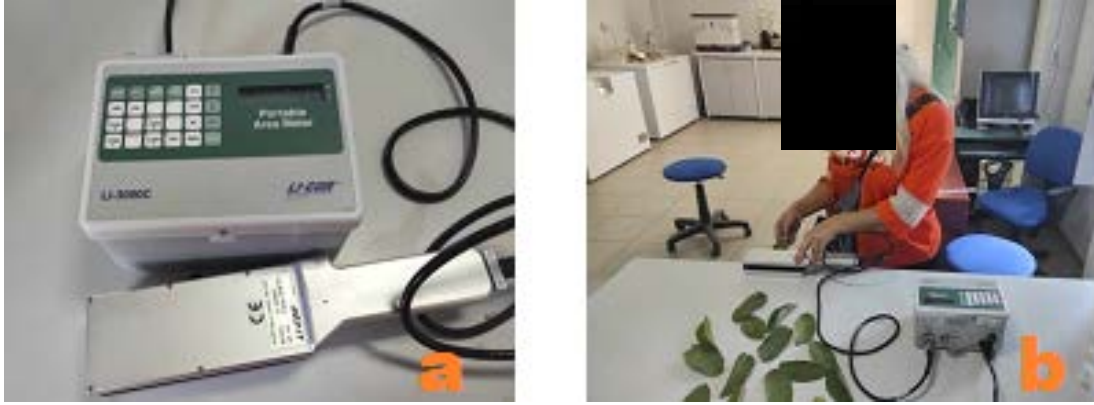
Şekil 3.10. Yaprak Alan Ölçümlerinin Yapılması (a: LI-COR marka LI-3000 C model portatif yaprak alanı ölçer, b: genel görüntü)
