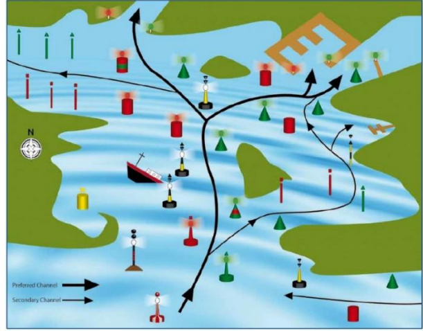
Şekil 2.15: IALA Sistem-A seyir yardımcıları.
