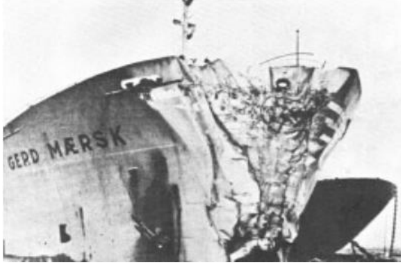
Şekil 2.23: Newport Köprü kazası, gemi hasarı.
