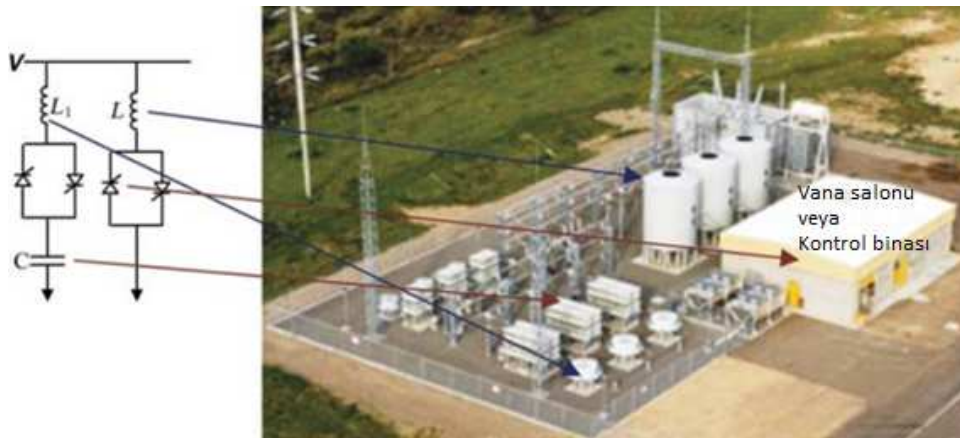
Şekil 1.4. Süper iletken ve Süper kapasitörün birlikte kullanıldığı bir EDS
