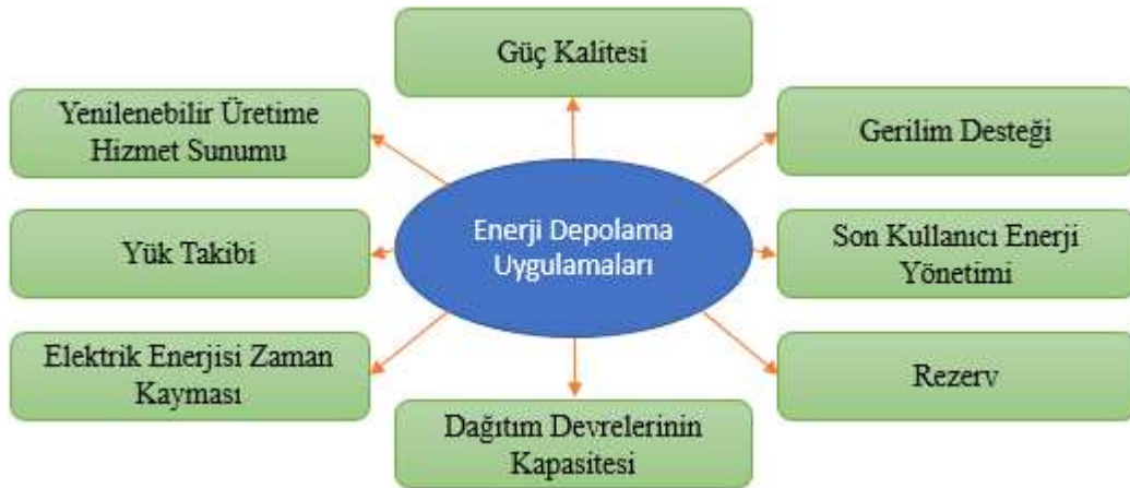
Şekil 1.3. Enerji depolamanın kullanıldığı bazı temel uygulamalar
