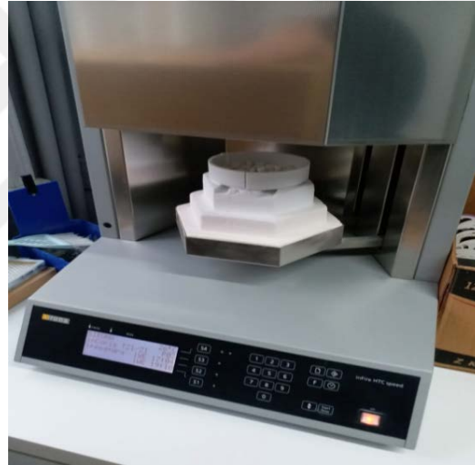
Resim 5. 3 Zr Alt yapılar Sinterizasyon Fırında
