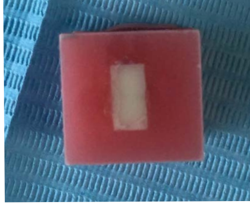
Resim 5. 9 Numunenin İşlem Yapılacak Yüzeyi Akriliğe Sıfırlanmış Halde Görüntüsü
