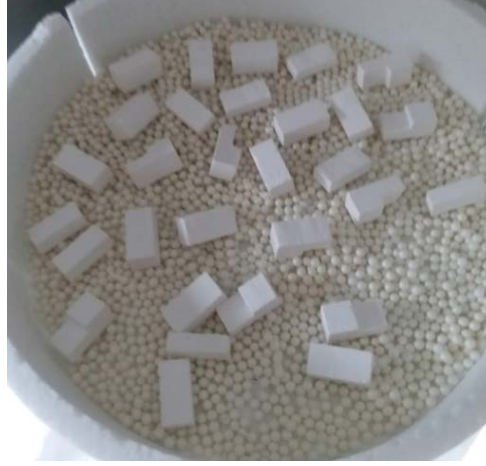
Resim 5. 2 Kazınan Zr Alt Yapılar Sinterizasyon Fırınına Girmeden
