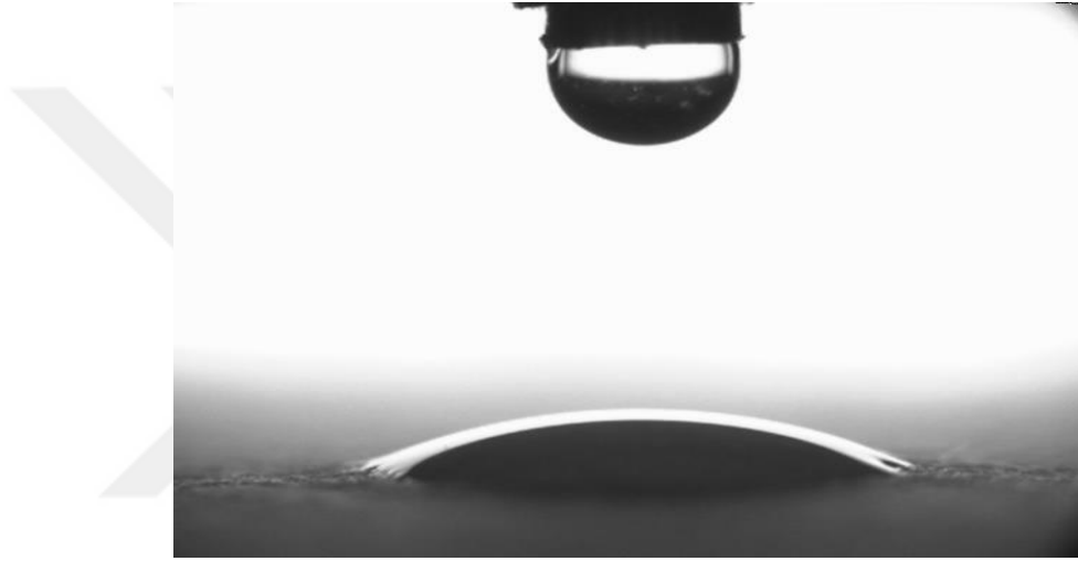
Şekil 4.9. I. Geri dönüşüm aşaması sonunda üretilen kağıda ait drop volume görüntüsü
