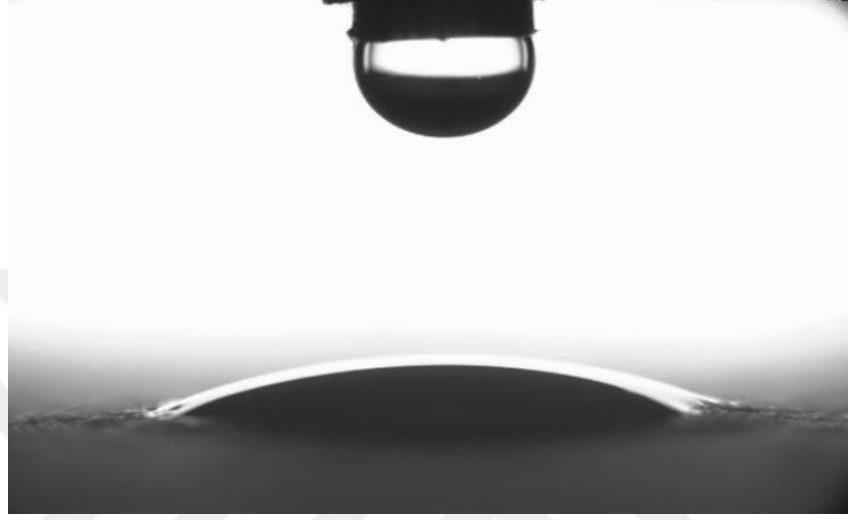
Şekil 4.49. VI. Geri dönüşüm aşaması sonunda üretilen kağıda ait drop volume görüntüsü
