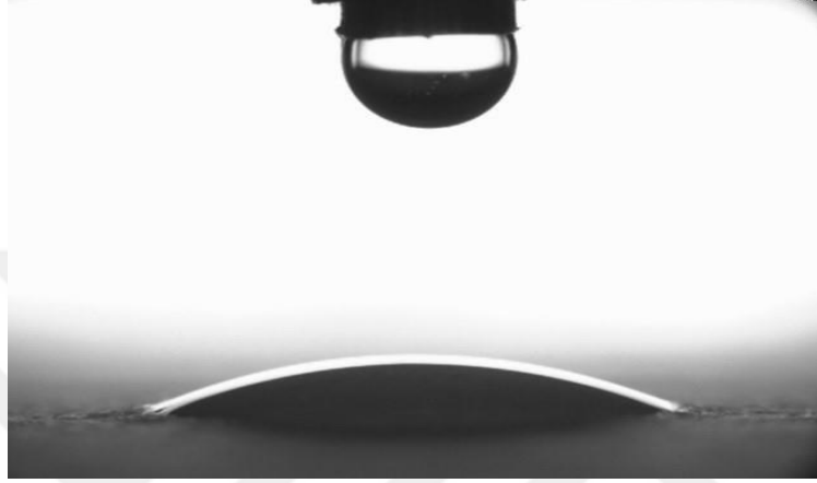
Şekil 4.26. III. geri dönüşüm aşaması sonunda üretilen kağıda ait drop volume görüntüsü
