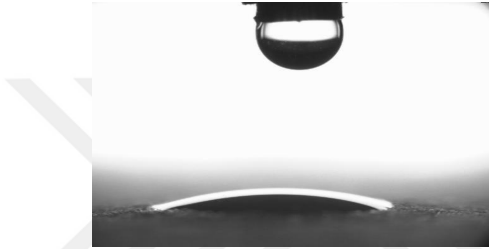
Şekil 4.13. II. Geri dönüşüm aşaması sonunda üretilen kağıda ait drop volume görüntüsü
