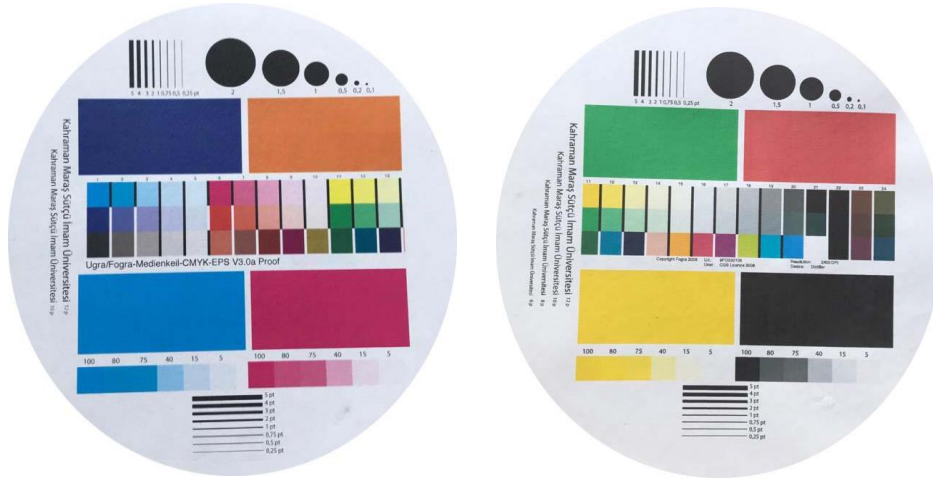
Şekil 3.4. Renk ölçümü için kullanılan CMYK ve RGB skalaları
