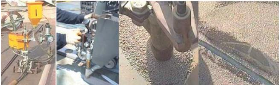
Resim 2.5 Kaynak bölgesine dökülen toz malzeme (Tama 2009).
