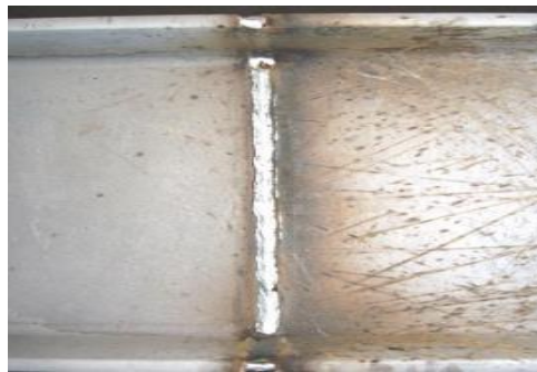
Resim 2.8 Küt kaynağın kiriş ekine uygulanması.
