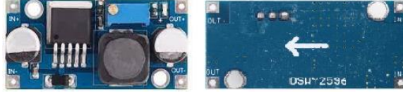
Şekil 4.13. LM2596 DC voltaj regülatörü görünümü
