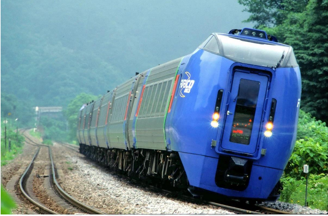
Şekil 3.7 Japon üretimi KiHa 283 serisi bir yatar gövdeli DMU (URL-3 2020).
