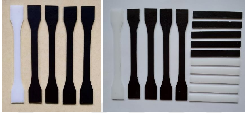
Resim 4.8 Numune hazırlama hızarında kesilen mekanik test numuneleri
