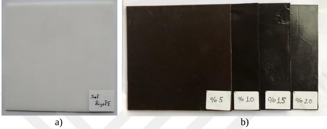
Resim 4.6 Saf BiyoPE (a) ve tıraş atığı içeren biyokompozit (b) örnekleri
