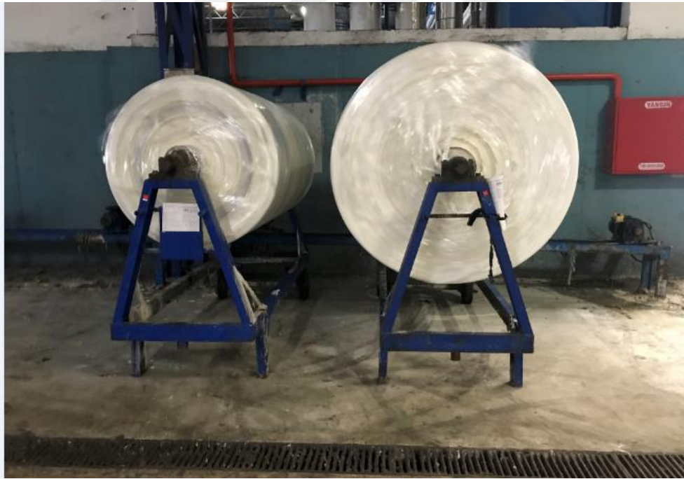
Şekil 2.4. Kasar Sonrası Döndürme İşlemi Yapılan Rolikler
