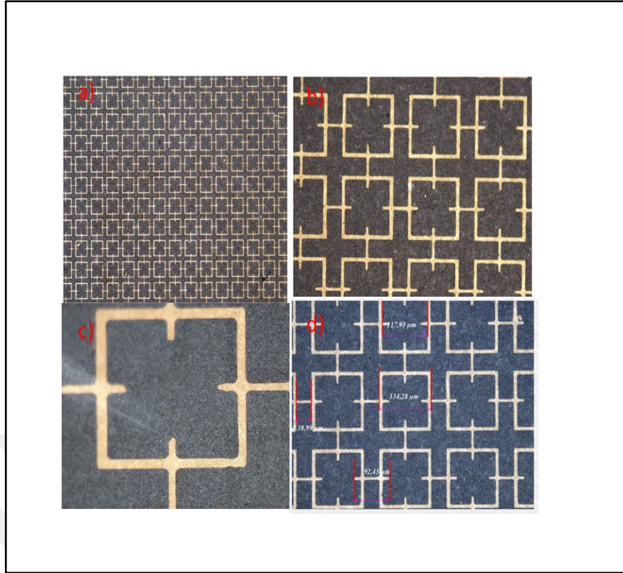
Şekil 3.8: (a-b-c) Fourcross VO 2 İnce film üzerine kaplanmış altın filtrelerin optik mikroskop görüntüleri. (d) Boyut ölçümleri görüntüsü.
