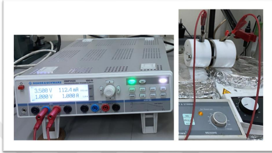
Şekil 3.8 Vanadyumun elektrolizinde kullanılan deney düzeneği
