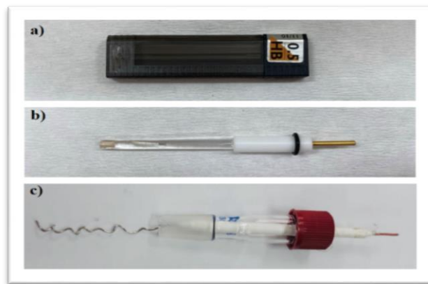
Şekil 3.10 Elektrokimyasal ölçümlerde kullanılan a) çalışma elektrodu (grafit kalem ucu elektrot), b) referans elektrot (Ag/AgCl) ve c) karşı elektrot (Pt tel)
