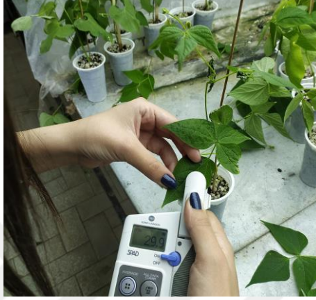
Şekil 3.10. SPAD metre cihazı ile klorofil ölçümü
