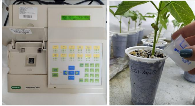
řekil 3.2. Spektrofotometrede bakteri yoęunluęunun belirlenmesi ve endofit bakterilerin uygulanması
