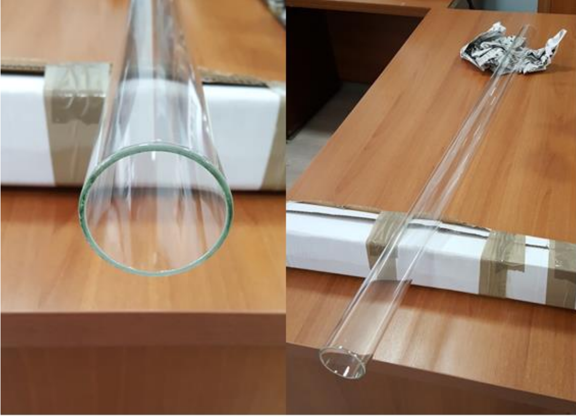
Şekil 3.15. Şeffaf borosilikat cam tüp
