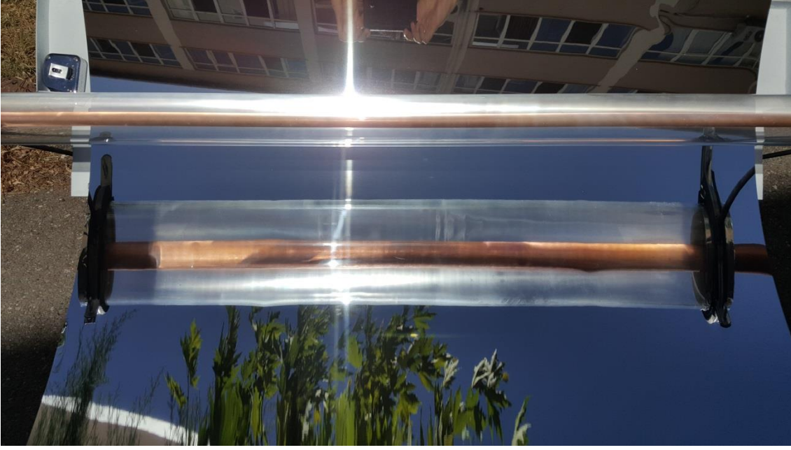
Şekil 3.11. Alüminyum yansıtıcı yüzeyin odaklayarak yansıtıcılığı
