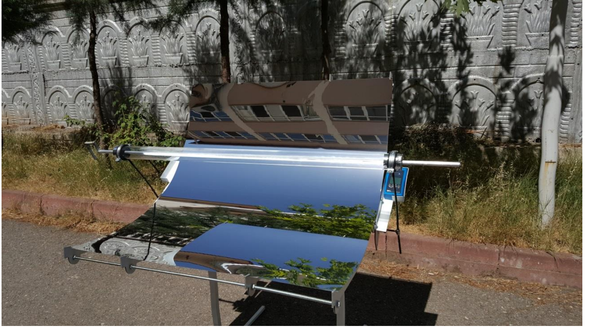
Şekil 3.1. Parabolik oluklu güneş kollektörü deney seti düzeneği
