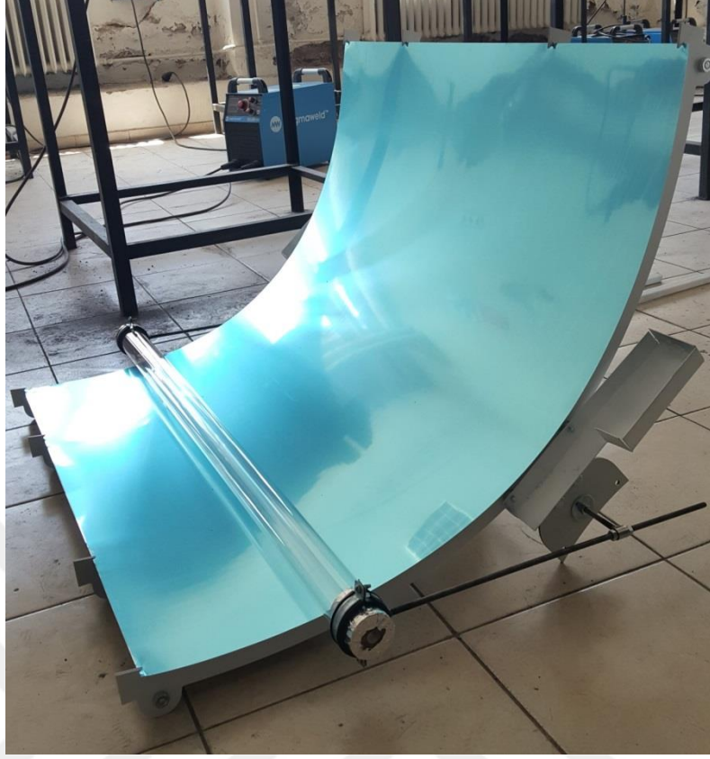
Şekil 3.7. Yansıtıcı yüzeyin parabolik oluk yay geometrisini yakalaması
