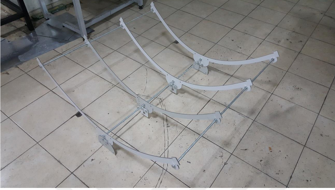
Şekil 3.6. Parabolik oluk montajlı şasesi
