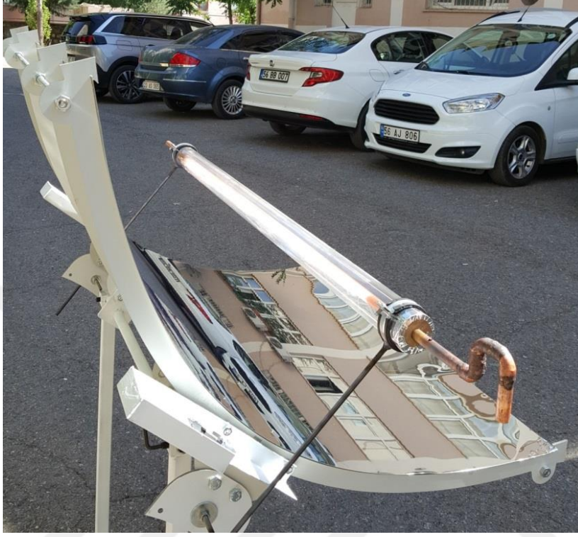
Şekil 4.5. Bakır boru ile kurulan deney seti
