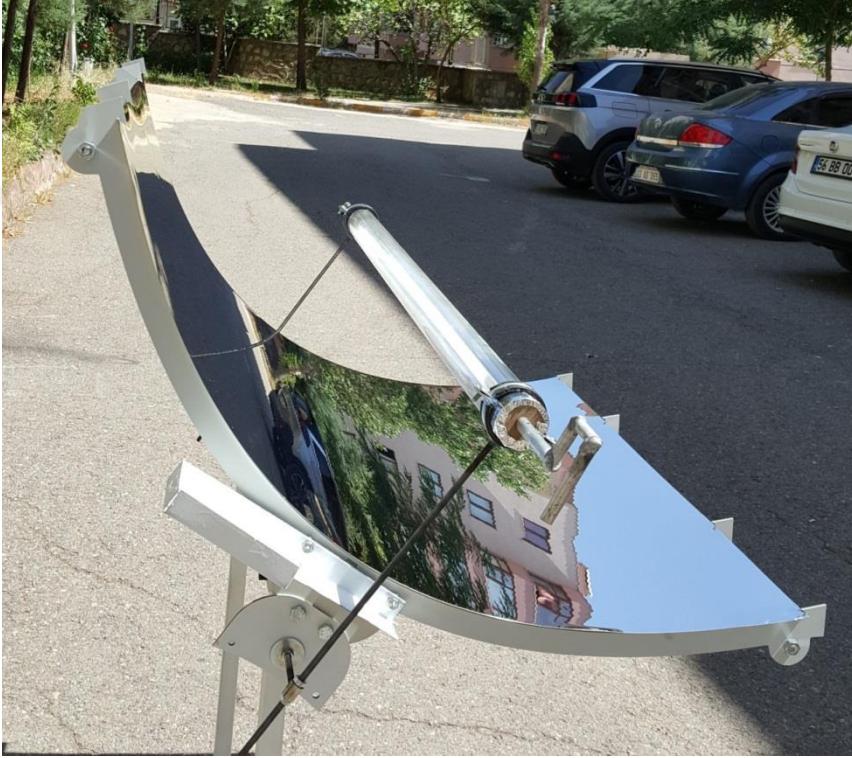
Şekil 4.9. Alüminyum odak borusu ile kurulan deney seti
