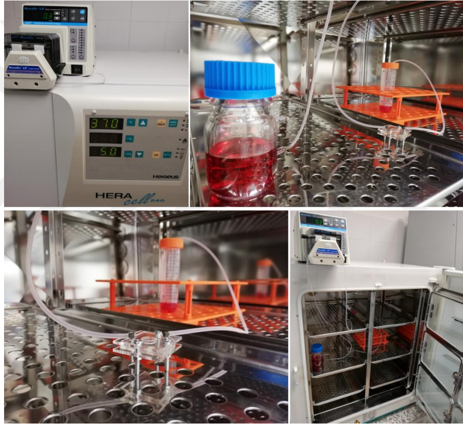
Şekil 3.8 3B perio/osteo mikro-doku taslaklarının mikroakışkan çip içerisindeki kültürüne ait fotoğraflar
