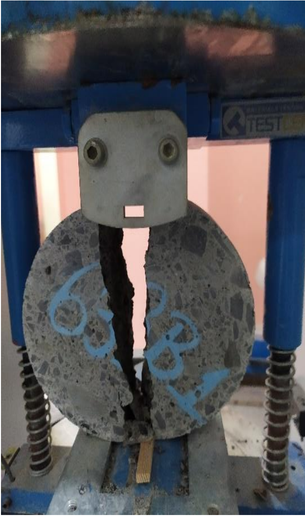
Resim 4.3. Yarma deney düzeneği
