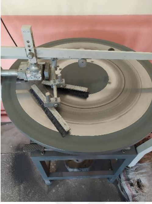
Resim 4.4. Aşınma (böhme) deneyi
