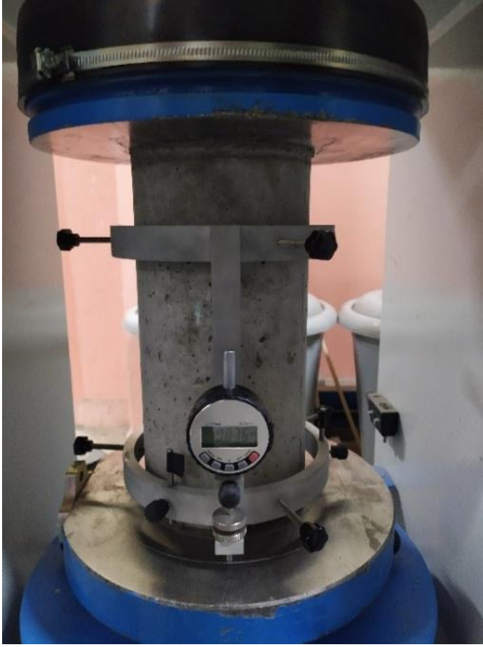
Resim 4.2. Elastisite deney düzeneđi
