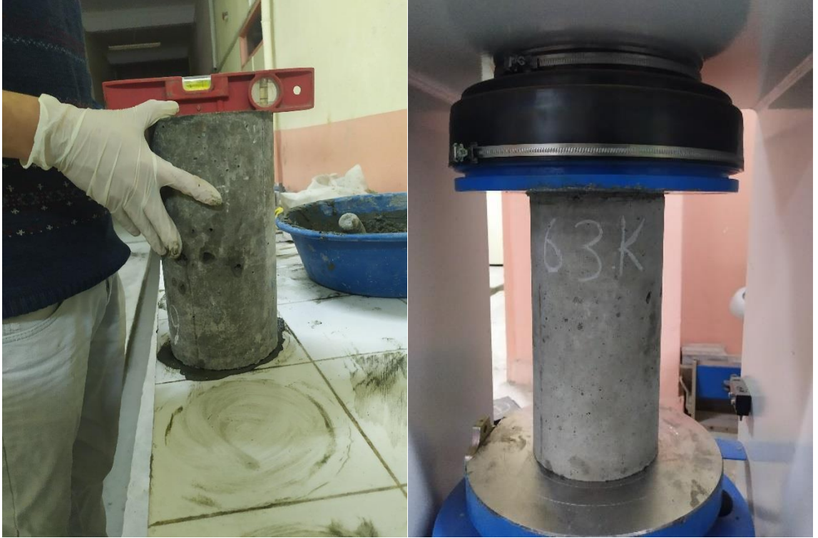
Resim 4.1. Basınç dayanımı düzeneği
