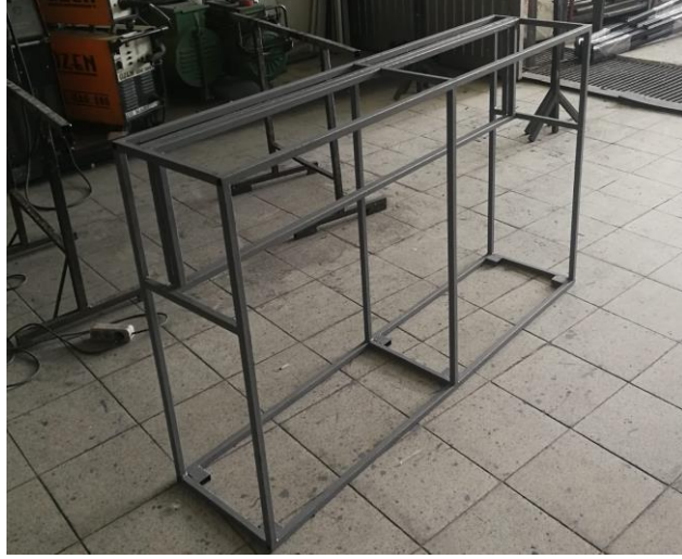
Görsel 95. Hologram standı için oluşturulan kompozitin şase kısmı
