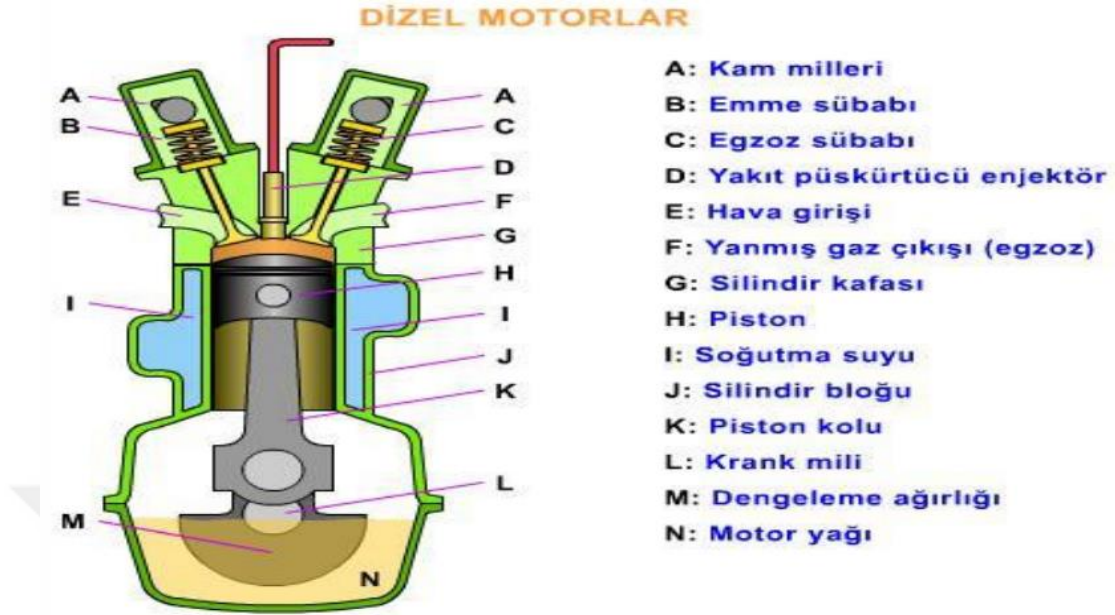
řekil 4.3: Dizel motorun kesiti ve alıřma prensibi [49]
