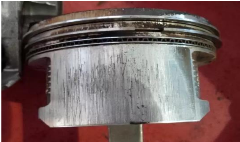
Şekil 4.4: Motor segman aşınması örneği [52]
