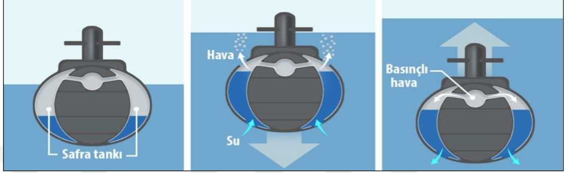
Şekil 2.24: Denizaltı sualtına dalış prensibi
