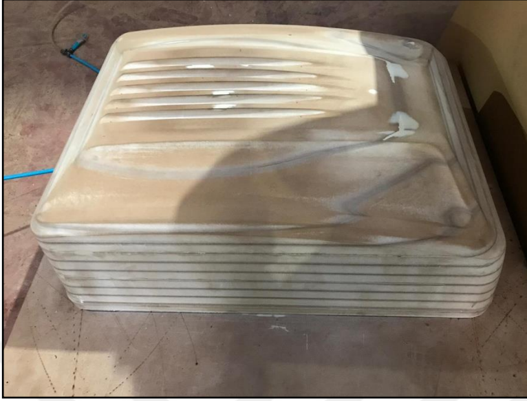
Şekil 3.25: Termoform üretim için geçici numune kalıbı
