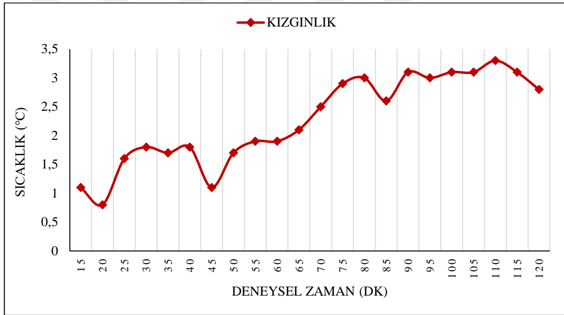
Şekil 6.3. Fanlı, nemlendiricili, titreşimli çalışma hali için buharlaştırıcı kızgınlığı.
