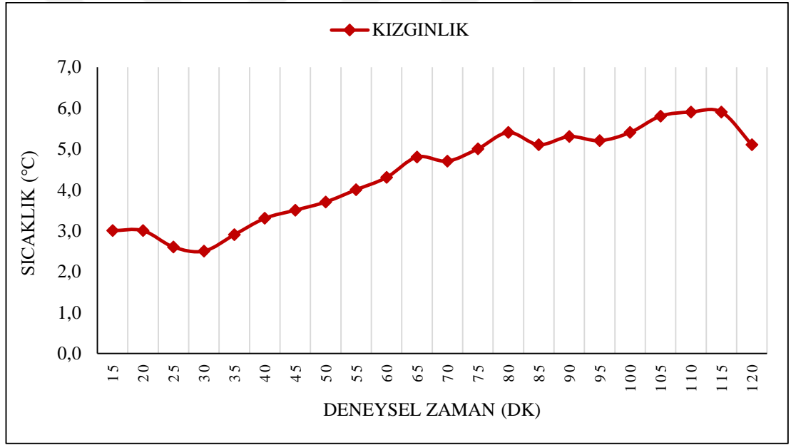
Şekil 6.2. Fanlı, nemlendiricili çalışma hali için buharlaştırıcı kızgınlığı.
