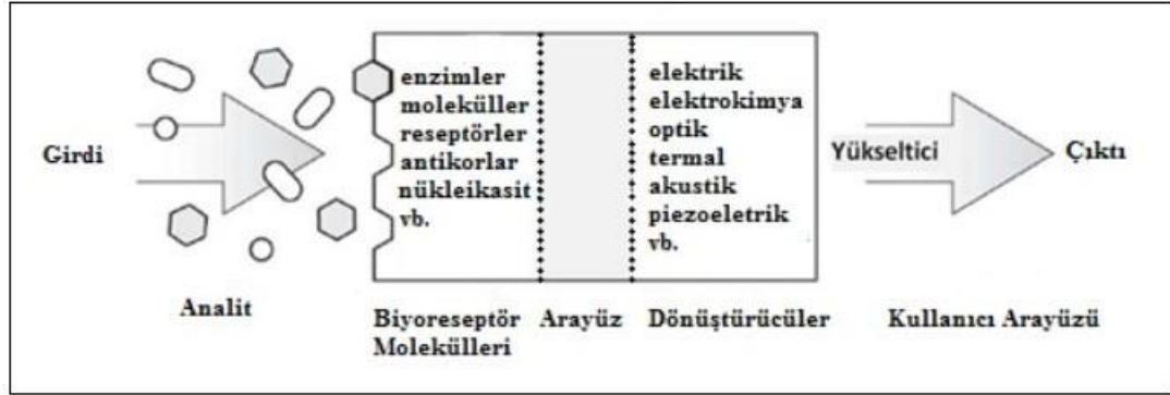
Şekil 1.6. Biyosensörün şematik gösterimi [47].
