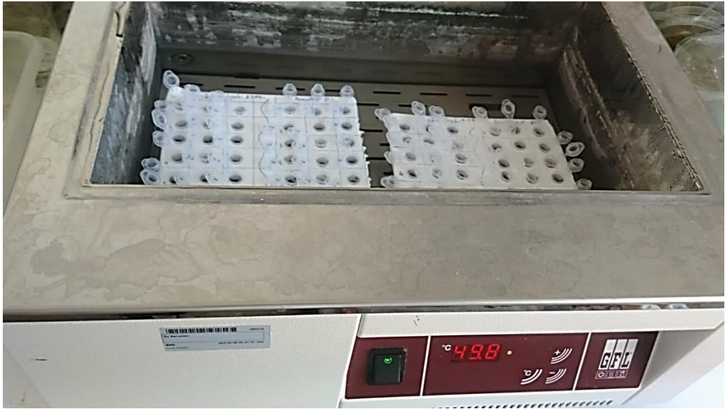
Şekil 3.7. β-1,4-glukanaz enzim ölçümünde inkübasyon işlemi
