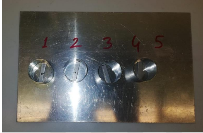
Resim 6.16. Bakalite konulan örnekler
