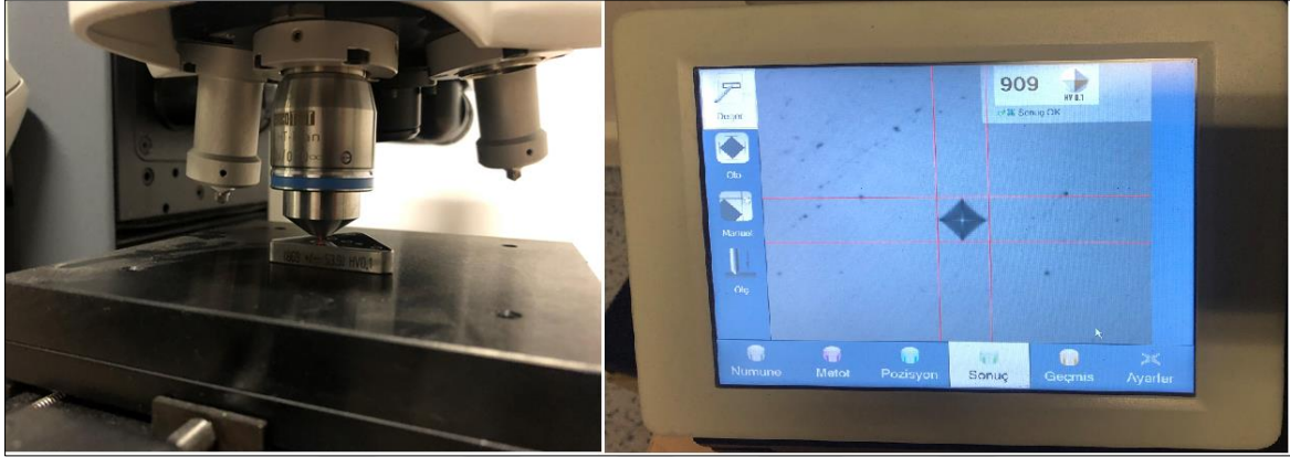
Resim 6.18. Sertlik cihazı ölçüm kalibrasyonu ve sonucu
