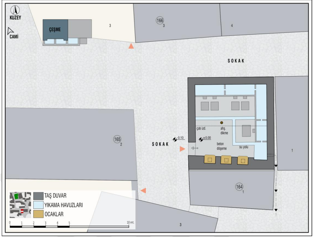
Şekil 4.18 : 164 Ada 1 Parselde Yer Alan Çamaşırhane Planı Rölövesi, 2019
