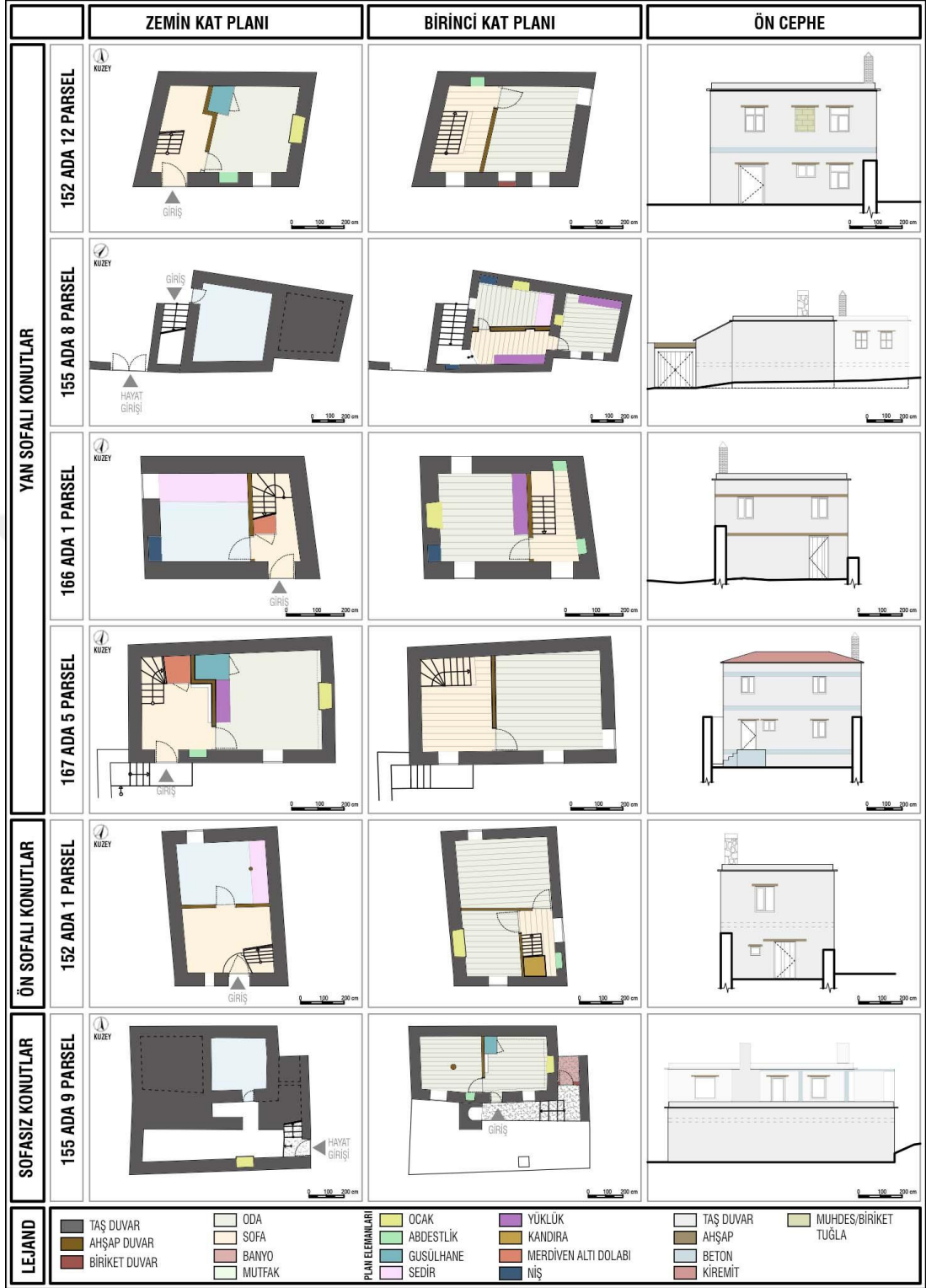
Şekil 4.49: İki Katlı Geleneksel Konutlarda Plan Tipolojileri
