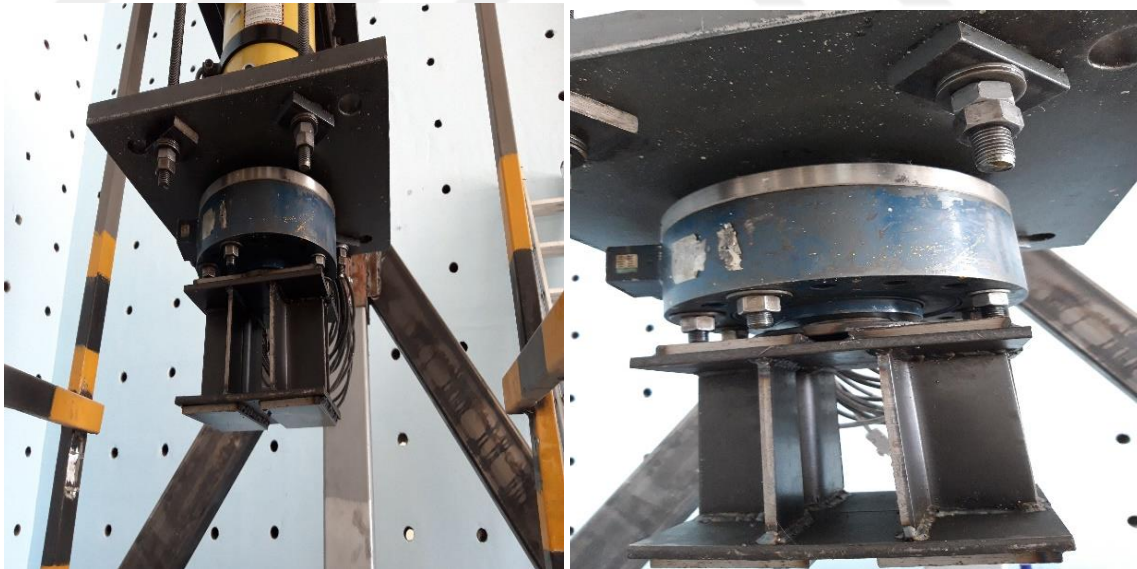
Şekil 2.30. Yükleme aparatının bağlanması
