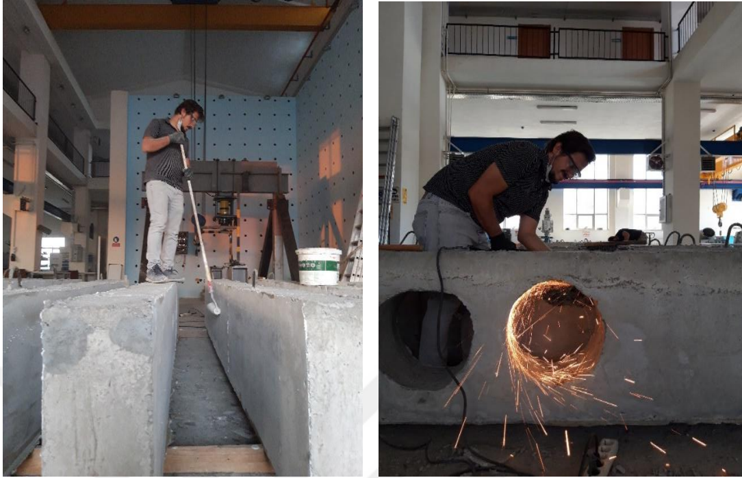
Şekil 2.25. Numunelerin boyanması ve pürüzlerinin giderilmesi
