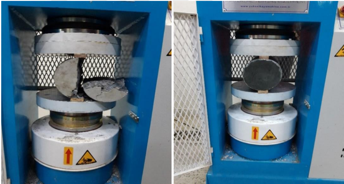
Şekil 2.23. Yarmada çekme testi deneyleri
