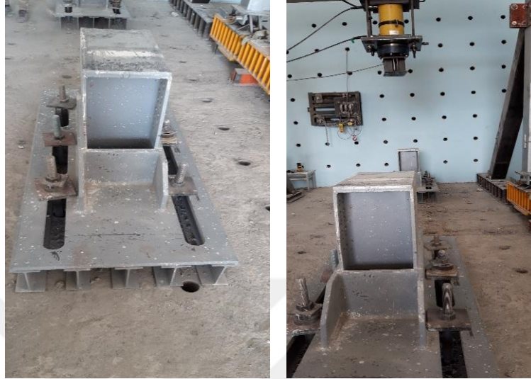
Şekil 2.27. Ankastre mesnet ayaklarının deney platformundaki konumları
