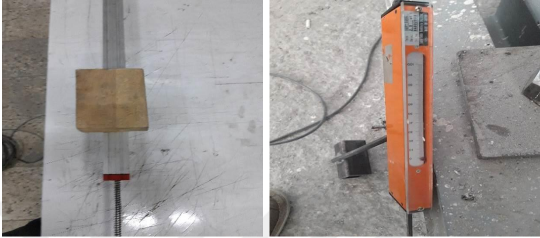
Şekil 2.37. Deplasman ölçerler ( LVDT ve Potansiyometrik Cetvel)
