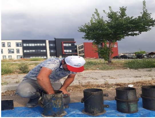
Şekil 2.14. Kalıpların desteklenmesi ve silindir numunelerin hazırlanması
