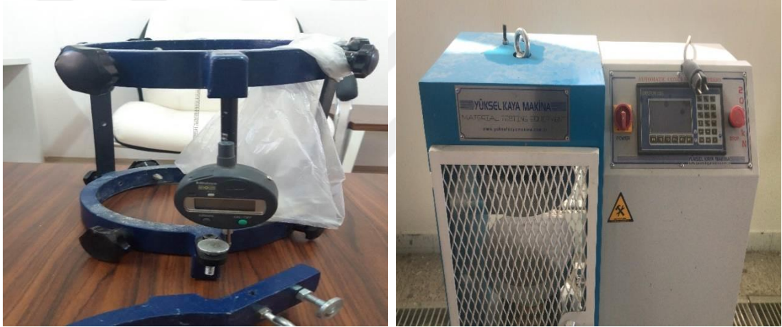
Şekil 2.20. Deplasman ölçer saat ve basınç test cihazı
