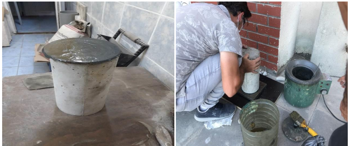
Şekil 2.21. Silindir numunelere kükürt başlık yapma işlemi
