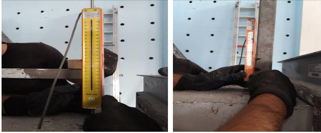
Şekil 2.39. Deplasman ölçerlerin bağlanması
