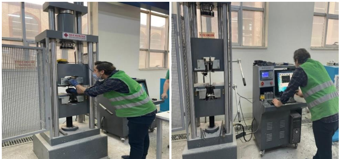
Şekil 2.24. Donatı numuneleri çekme deneyleri
