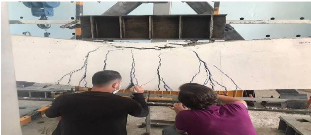
Şekil 3.18. R-2 numunesinin çatlaklarının ölçülmesi
