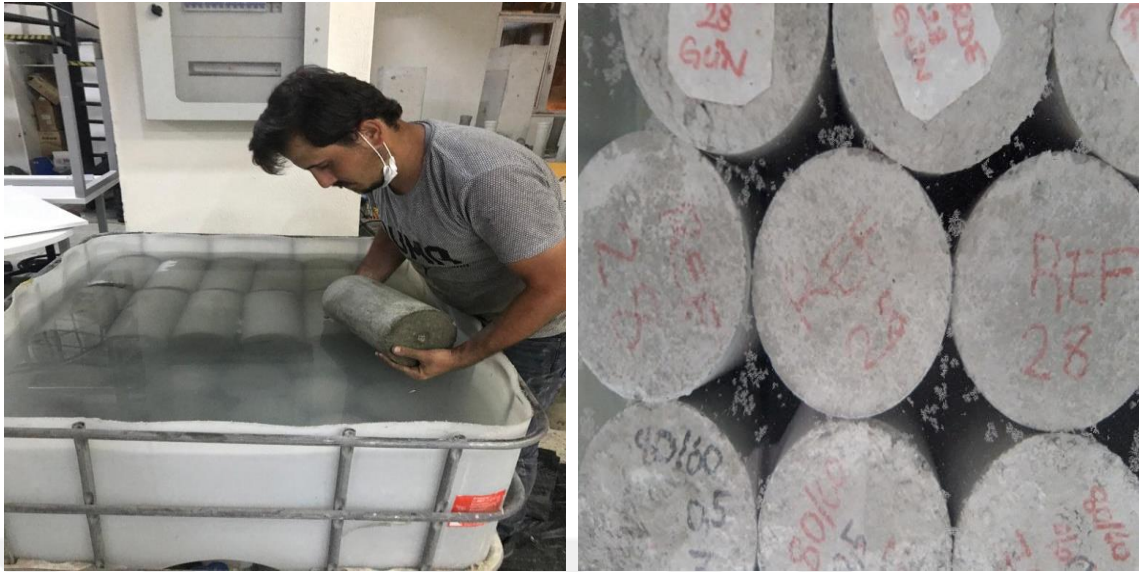
Şekil 2.18. Silindir numunelerin kür havuzuna konulması
