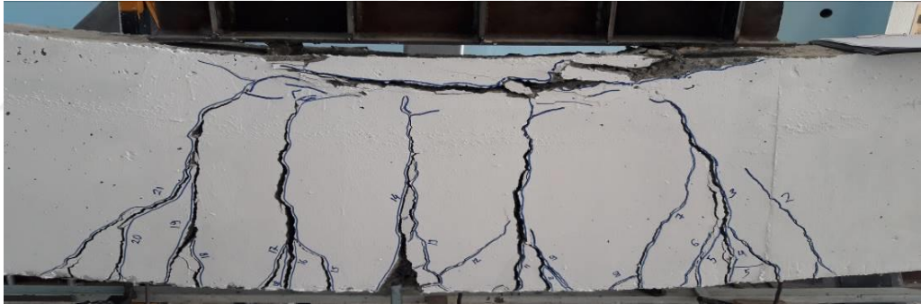
Şekil 3.17. R-2 numunesinin deney sonrası eğilme çatlak detayları
