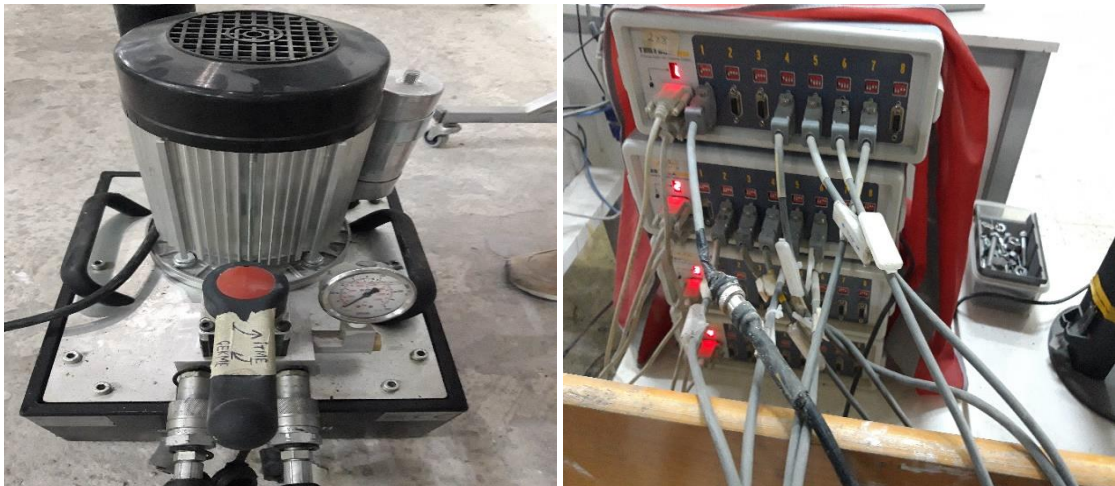
Şekil 2.36. Elektrikli motor ve veri toplama cihazı
