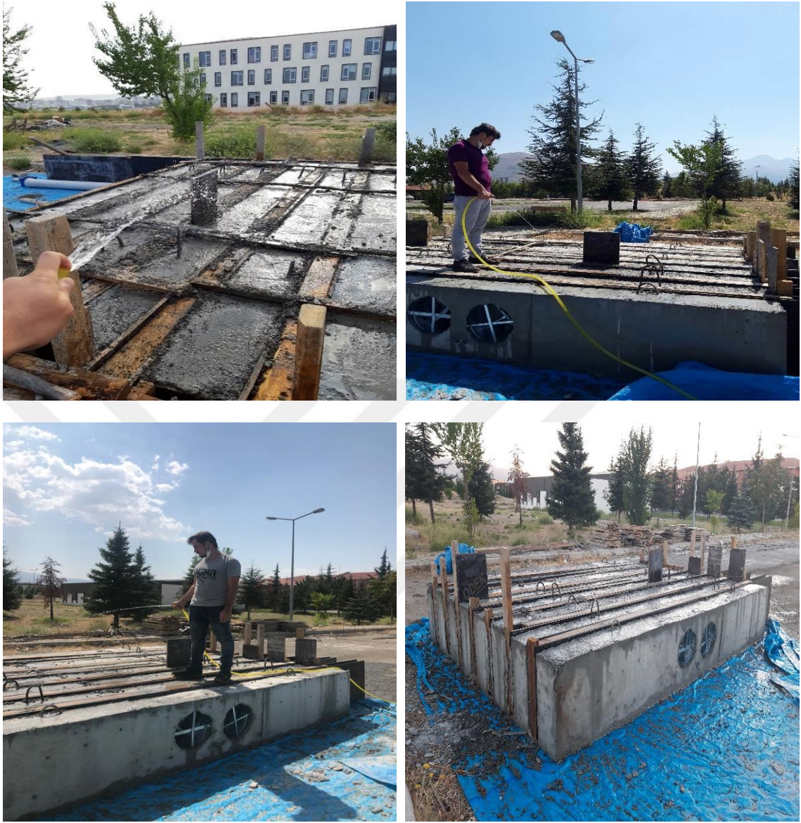
Şekil 2.17. Deney numunelerinin kür işlemi
