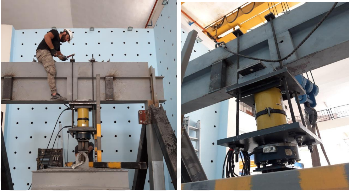
Şekil 2.29. Yükleme düzeneğinin bağlanması ve sabitlenmesi
